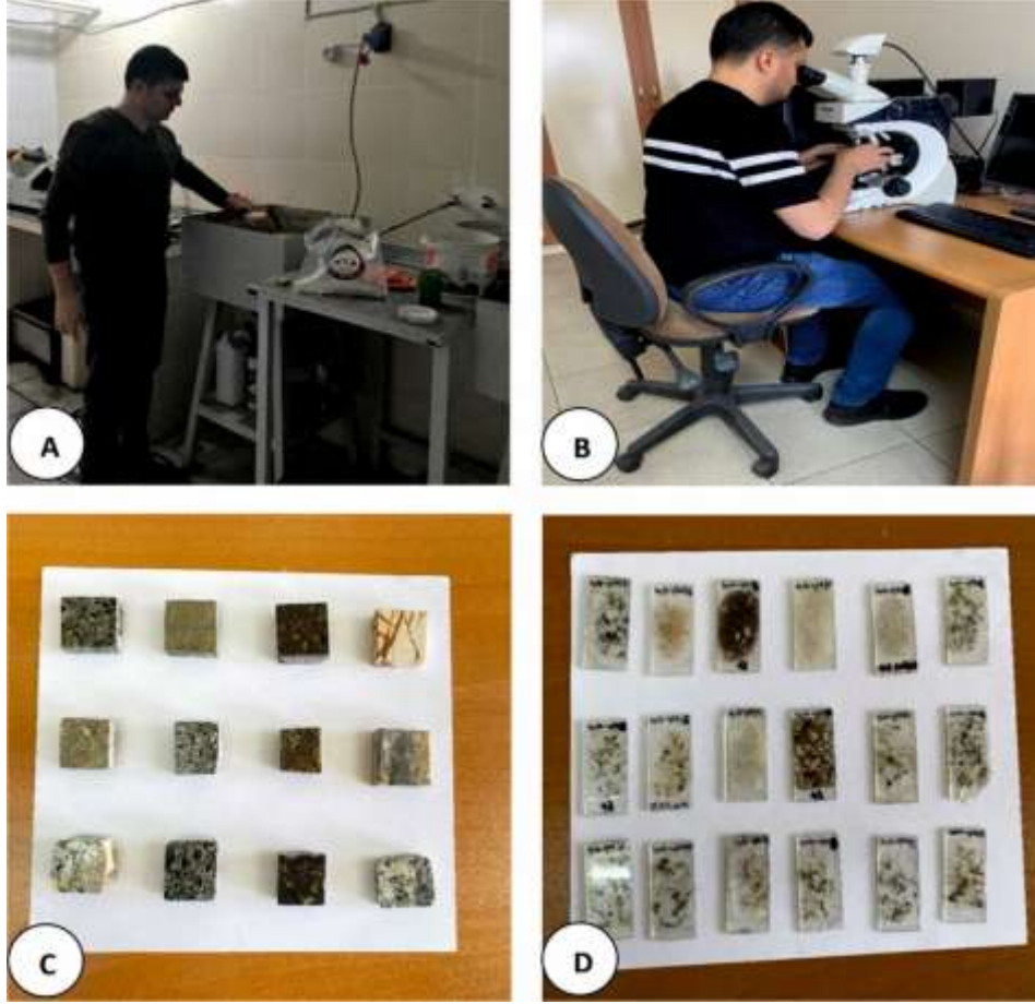
Şekil 2. A-B) Kayaç örneklerinin hazırlanması ve incelenmesi , C-D) İnce ve Parlak kesit örnekleri.
