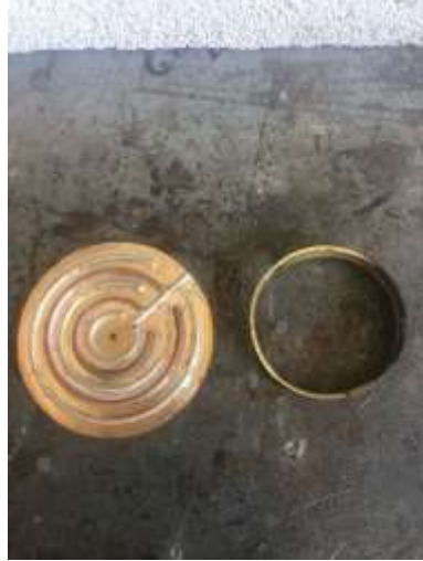
Görsel 17: Pirinç Astandan Kesilerek Çember Formuna Getirilmiş Dış Duvar
