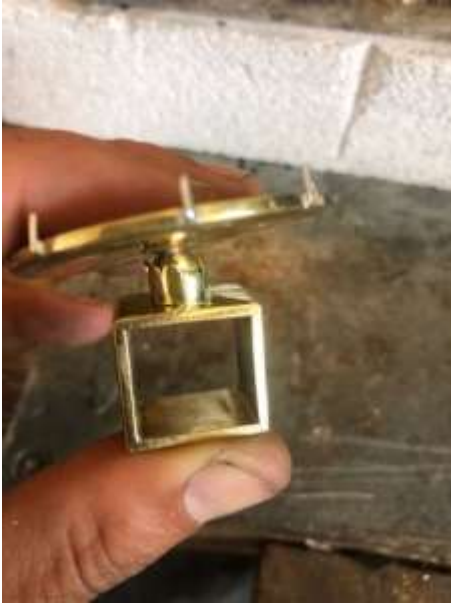
Görsel 34: Ana Parça ve Yüzük Kolunu Eklem Noktasından Birleştirme
