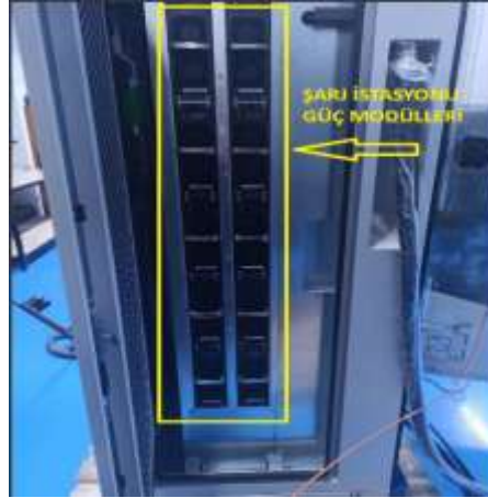
Resim 3 : DC Şarj içerisindeki Güç Modülleri
