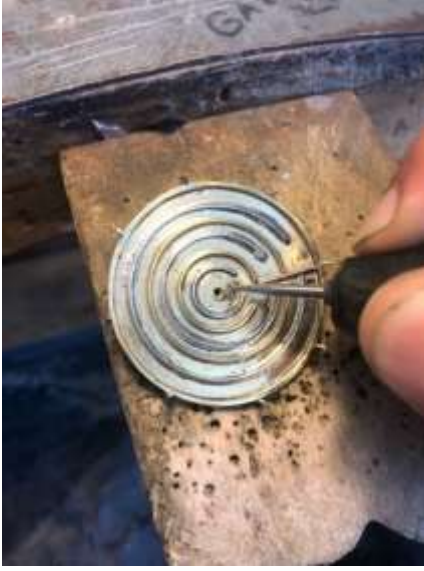
Görsel 32: Freze ile Taş Yuvası Açma
