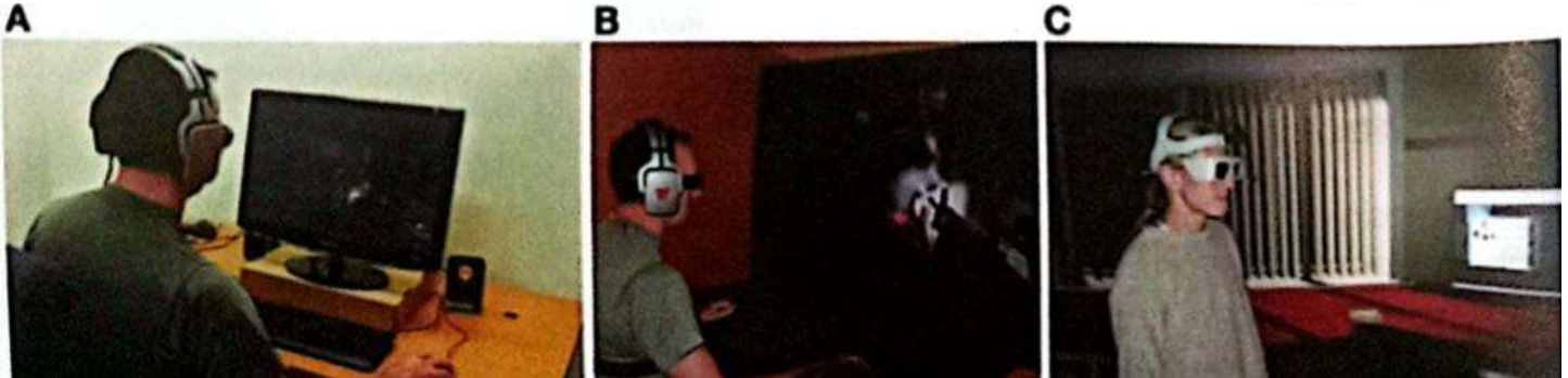
Şekil 1. Daldırma seviyeleri örnekleri: (a) non-immersive sanal gerçeklik sistemi, (B) semi-immersive sanal gerçeklik sistemi ve (C) immersive sanal gerçeklik sistemi.
