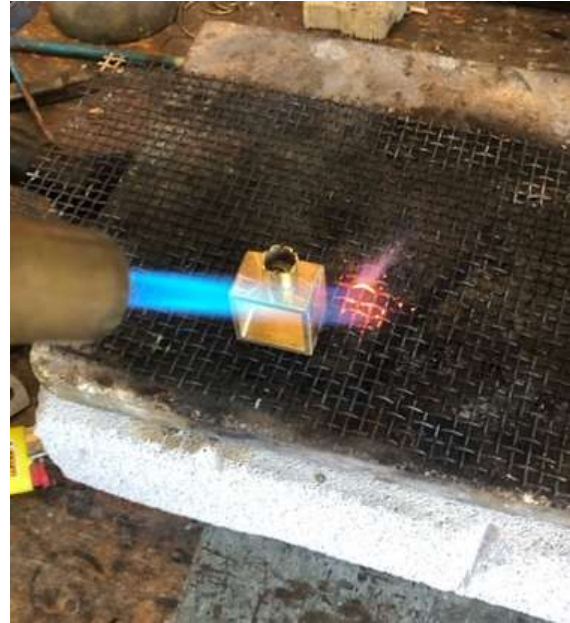
Görsel 31: Yuva ve Yüzük Kolunu Kaynak ile Birleştirme
