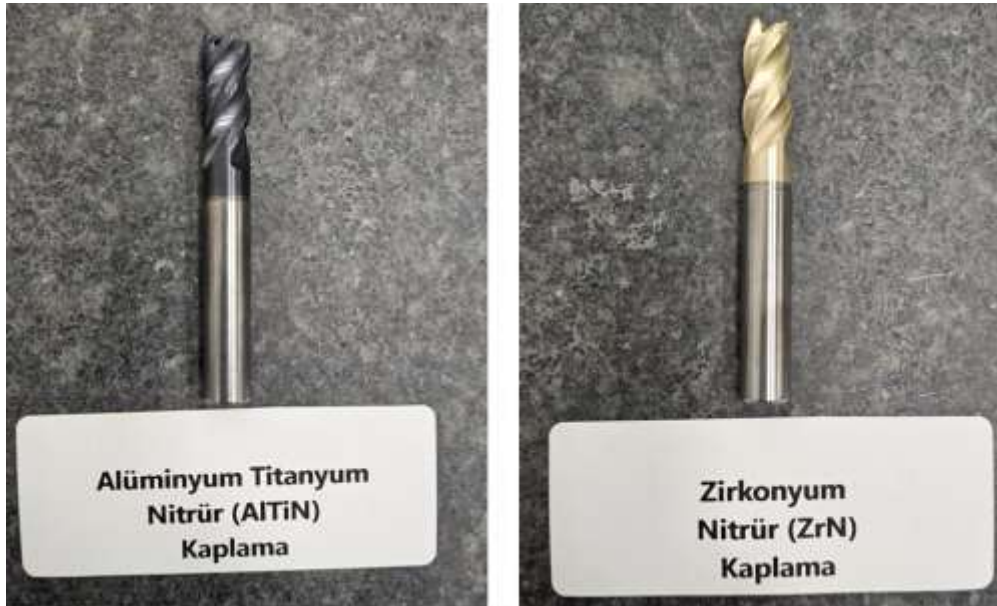
Şekil 1. Kullanılan parmak freze kesici takımlar
