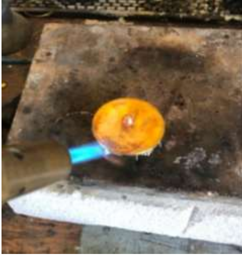
Görsel 28: Ana Parça ve Küreyi Kaynak ile Birleştirme
