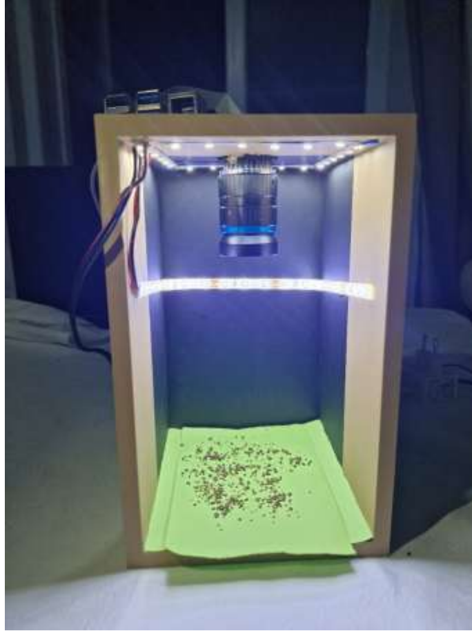
Şekil 15. Kahve Çekirdeği Görüntü Toplama Kabini
