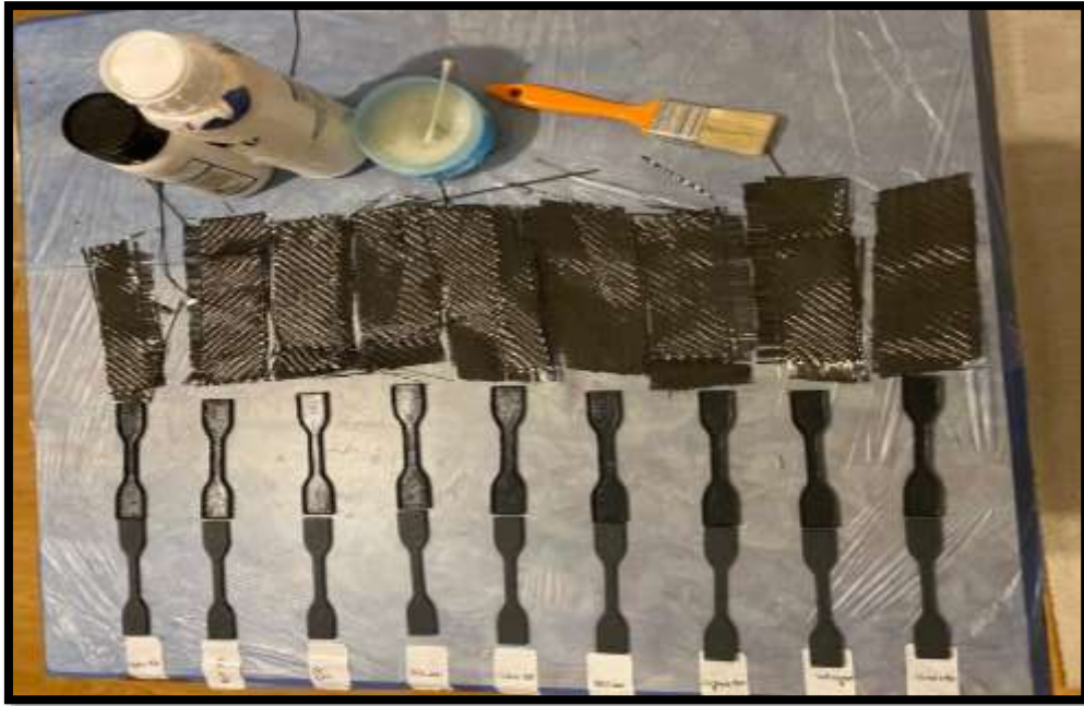
Şekil 8. Karbon elyaf el yatırma ön hazırlık
