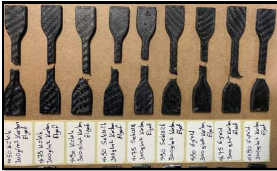
Şekil 14. Çekme testi sonrası 300gr/m 2 karbon elyaf kaplamalı numuneler
