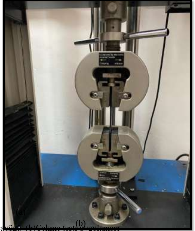
Şekil 12. UTEST Profil X6 Cihazı (a)Test cihazı arayışı (b)Çekme testi uygulaması
