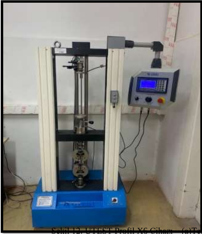
Şekil 12. UTEST Profil X6 Cihazı (a)Test cihazı arayışı (b)Çekme testi uygulaması
