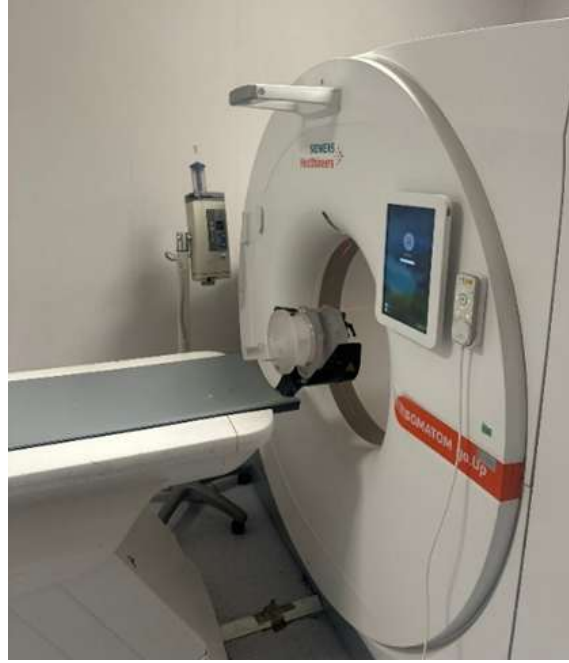
Şekil 1. Somatom Go.Up 16 Slice BT cihazı ve fantom (Wire in Air Phantom)
