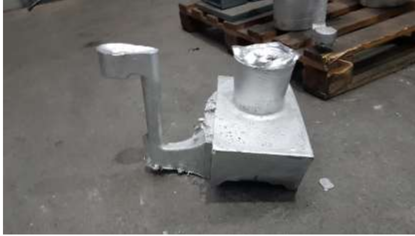
Şekil 5. Desen segmentlerinin metal kalıba döküm işleminden sonraki görünüşü
