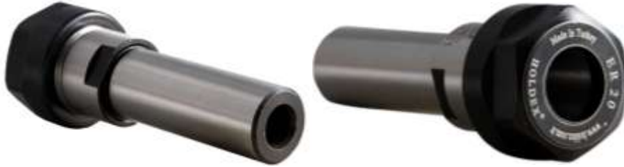
Şekil 7. Spesimen tespitinde kullanılan silindirik saplı pens tutucular
