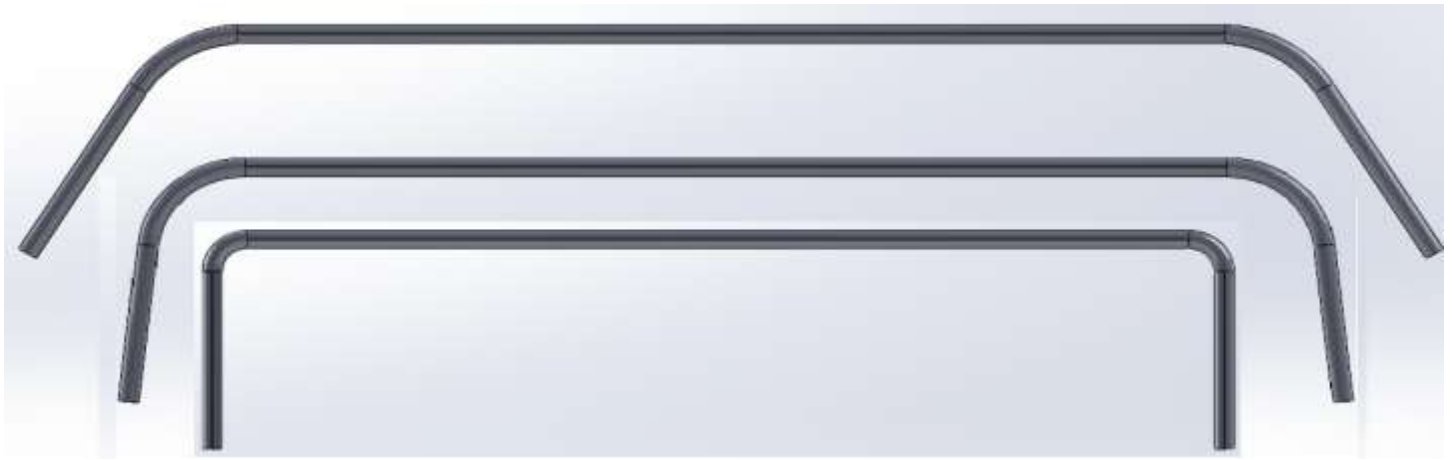
Şekil 2 Farklı açılarda tasarlanan viraj denge demirleri CAD görünüşü
