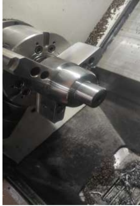
Şekil 8. Kasnakların CNC torna tezgahında işlenmesine ait görüntü
