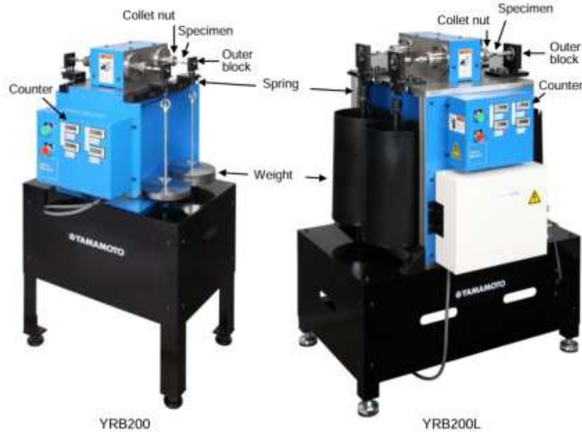
Şekil 4. Yamamoto ve arkadaşlarımız geliştirdikleri fatigue test ünitesi (Yamamoto et al., 2012)
