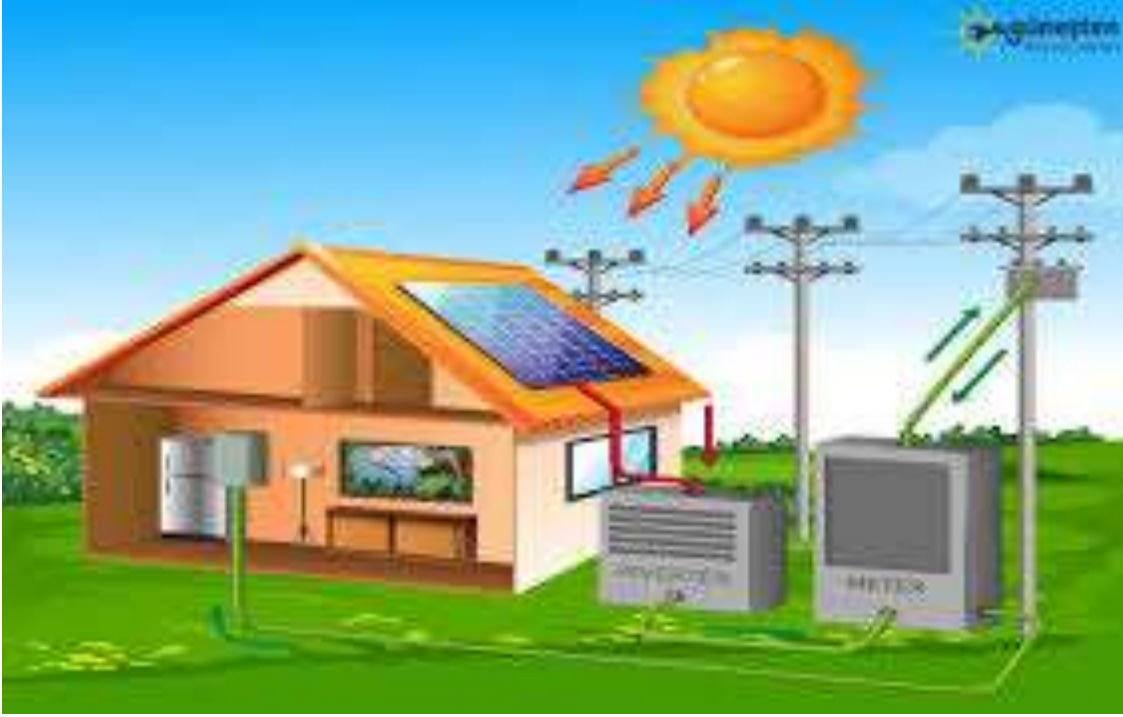
Şekil 1. Fotovoltaik sistem bileşenleri (NREL, 2021).
