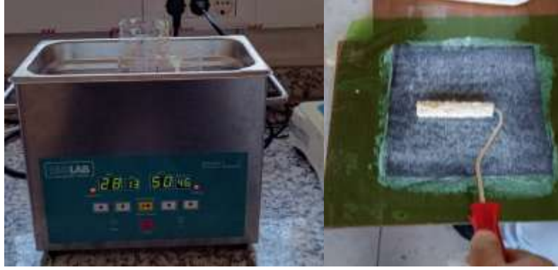
Şekil 1. Dolguların ultrasonik karıştırıcı ile karıştırılması ve kompozit plaka üretimi
