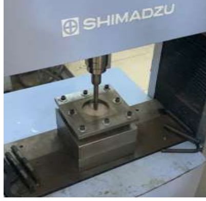
Şekil 1. Yarı statik delme kesme deneyi düzeneği
