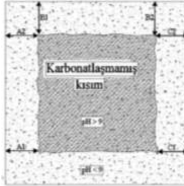
Şekil 3. Beton yüzey kesiti fenolftalein çözeltisi sıkılmış ve renk değiştirmiş yüzey tasviri [12-14].
