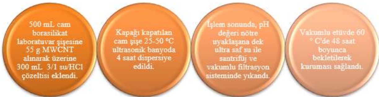
Şekil 1: Ticari MWCNT'ün saflaştırılması
