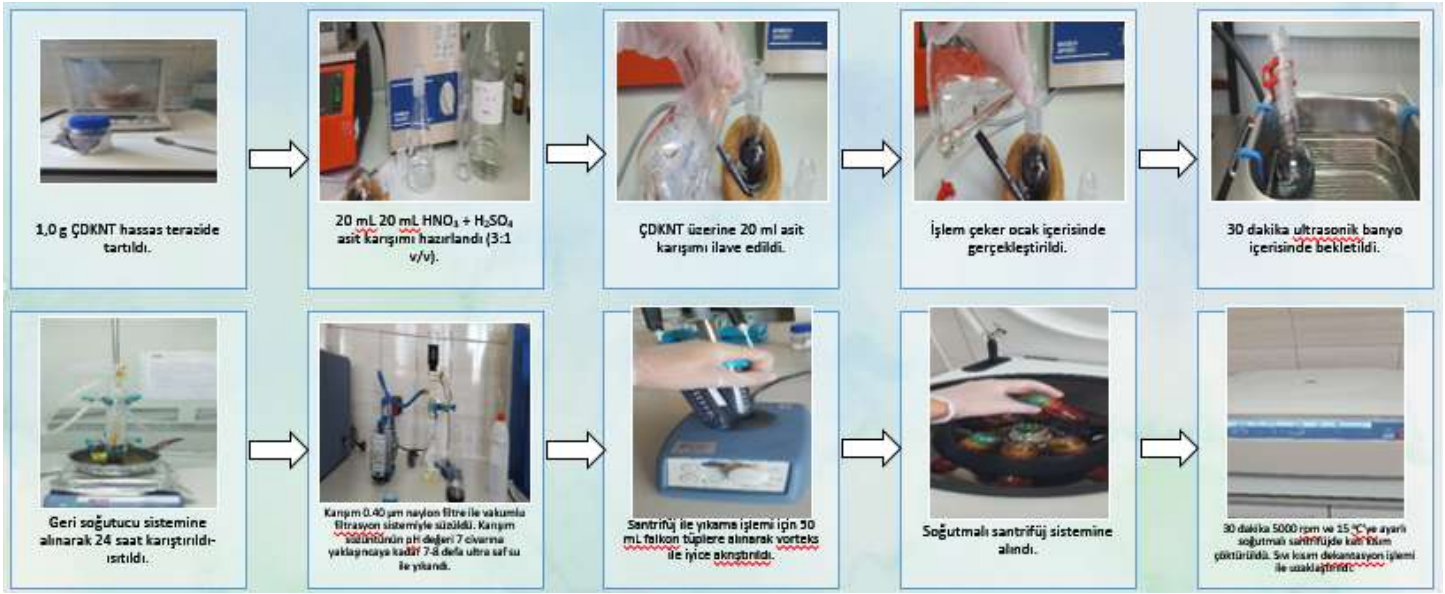
Şekil 1: MWCNT-COOH bileşiğinin sentez şeması
