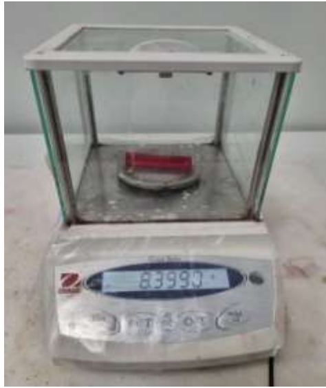
Şekil 3 OHAUS Carat PAJ1003C hassas terazi cihazı
