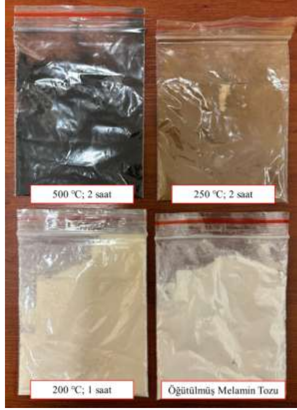
Şekil 2. Belirlenen sıcaklık ve süre parametreleri ile ısıl işlem sonrası elde edilen tozlar
