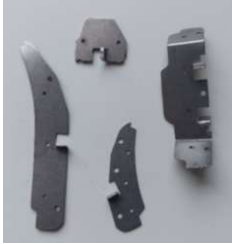
Şekil 1. Sac malzemelerden imalatı yapılmış olan 2D kerf örnekleri
