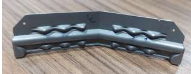
Şekil 3. Eklemeli imalat yöntemi ile imal edilmiş 3D kerfın görünüşü
