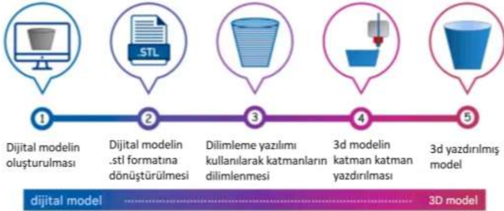
Şekil 1: FDM Üretim Aşamaları [2]
