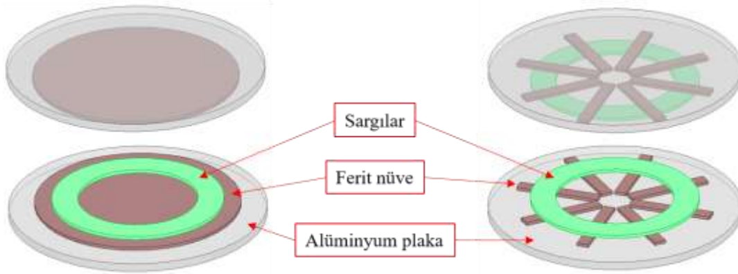
Şekil 3. EAD'da kullanılan metal ekranlamalı dairesel bir sargı çifti örneğinin 3D görünümü
