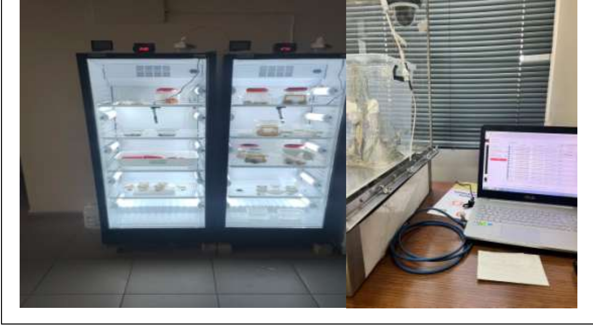
Şekil 3. İklimlendirme Dolabı ve Bireylerinin Hareketlerinin İzlendiği CO 2 Kabini ve Bilgisayar
