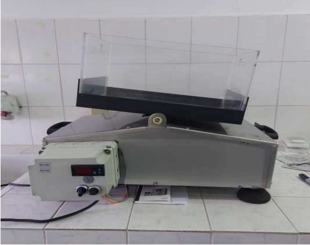
Şekil 1. Sularda parçalanma deneylerini gerçekleştirmek için kullanılan slosh-box isimli cihaz sunulmaktadır.
