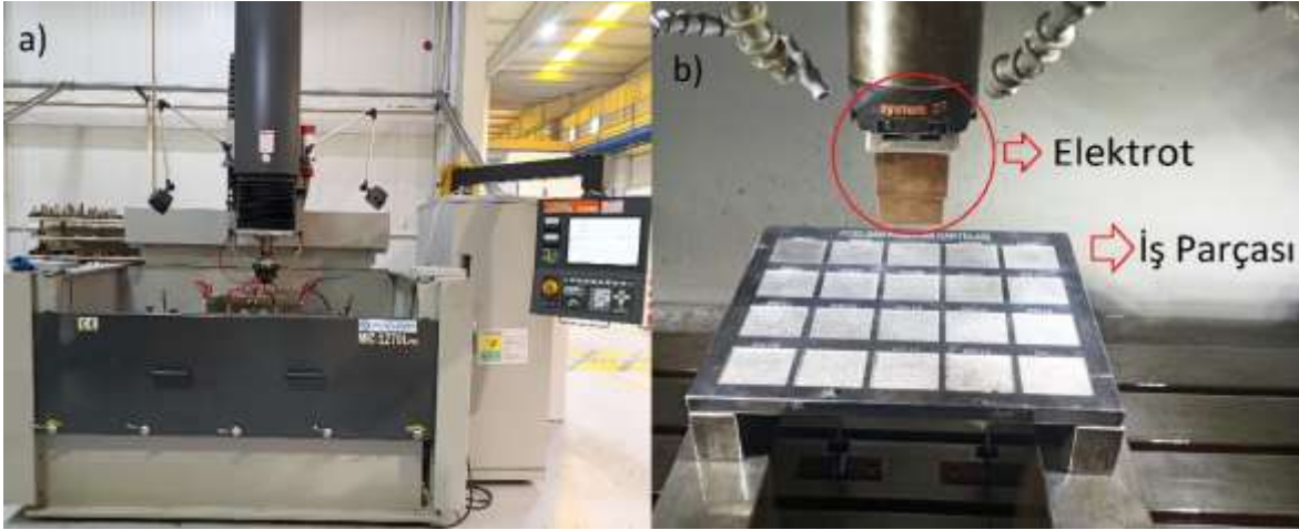
Şekil 6. EEİ prosesi a) Ecowin 1270L tezgâh görüntüsü, b) işleme sırasındaki görünüm
