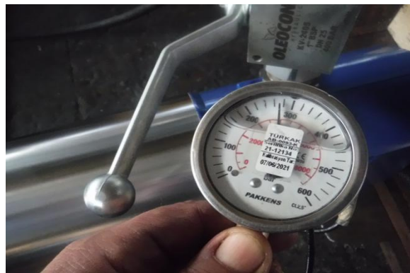
Şekil5. Hidrolik silindirin basınç testi
