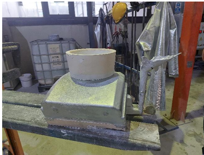
Şekil 3. Desen segmentlerinin döküm işlemi sonrası resmi
