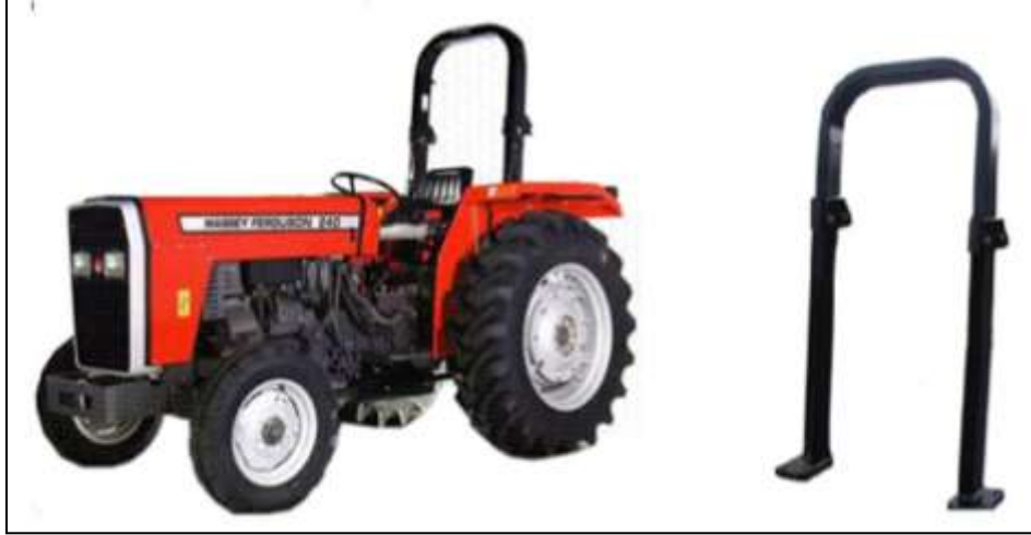
Şekil 1. Tarım traktörlerinde kullanımı zorunlu rops örneği
