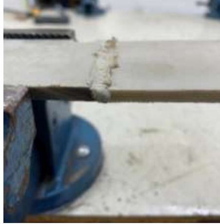
Şekil 5. SKK işlemi ile birleştirilmiş PEEK numunesi
