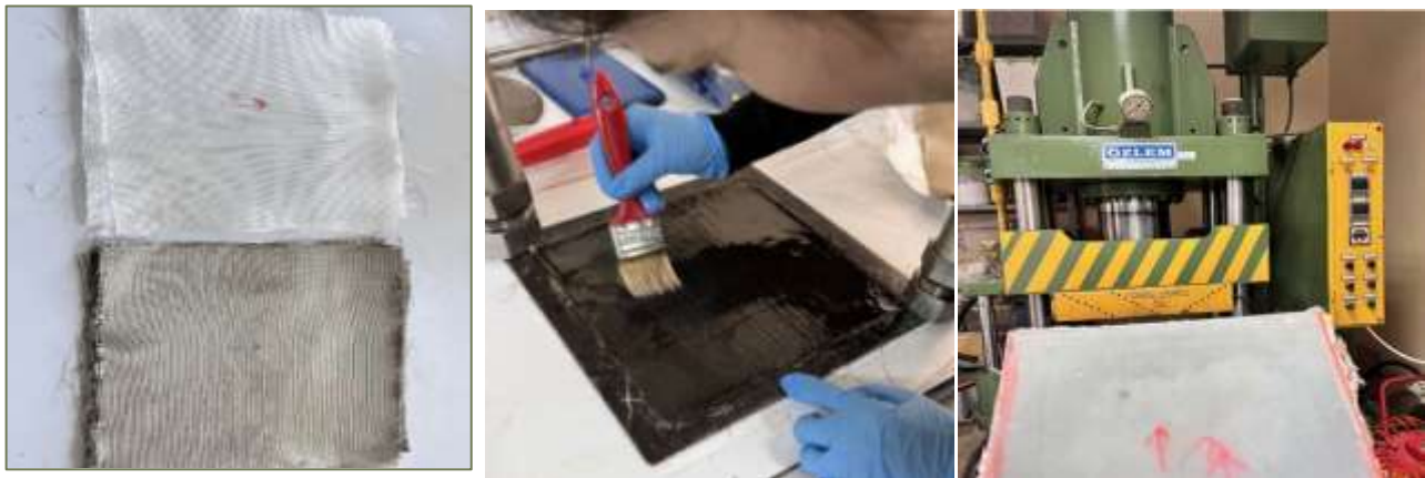
Şekil 1. Tabakalı kompozit malzemelerin üretim aşamaları
