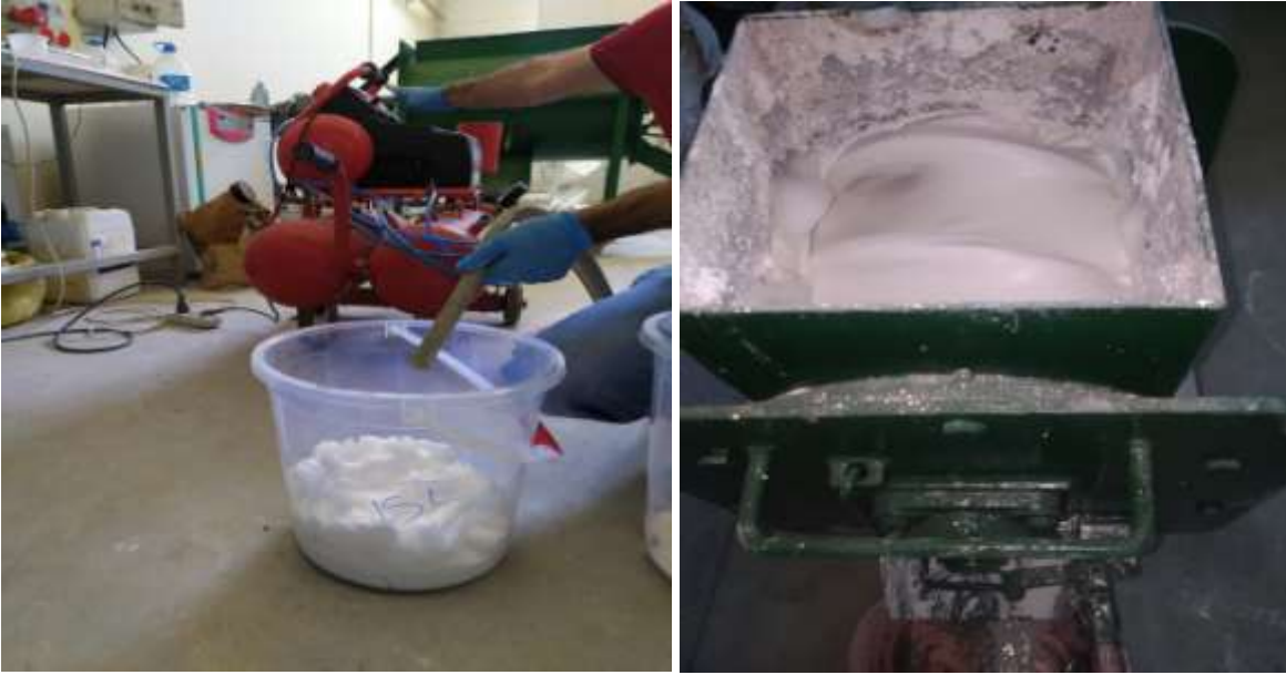
Şekil 1. Köpük üretimi ve üretilen köpük ile beton yapımı (Şeker, Gökçe)
