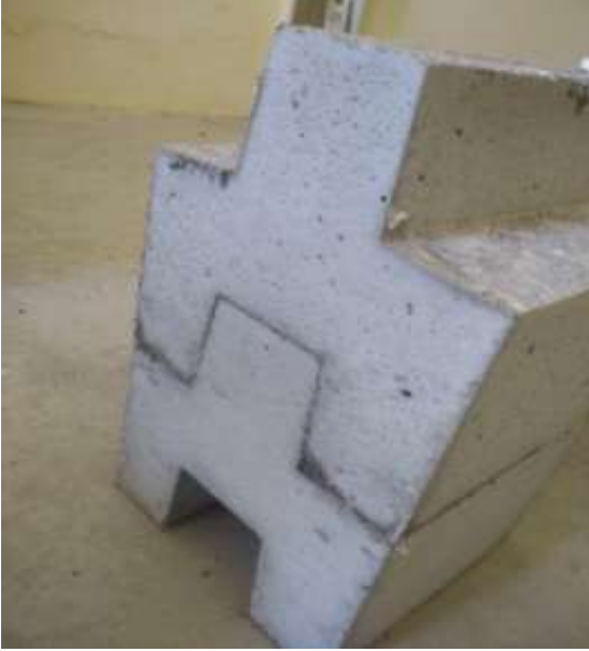
Şekil 2. Lego betonların birbirine geçme görüntüsü
