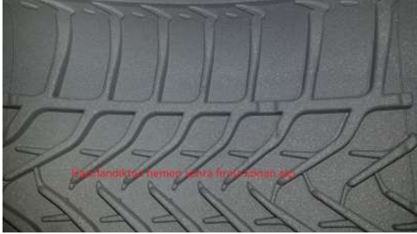
Şekil 6. Alçının fırında uzun süre bekletilmesi sonucunda desen segmentlerinin görünüşü
