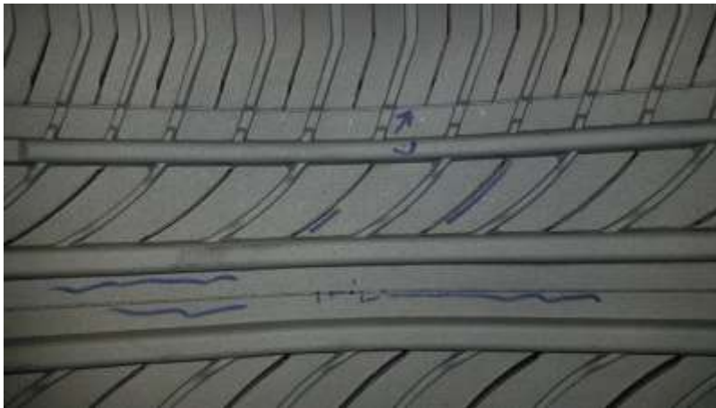
Şekil 5. Desen segmentlerinde meydana gelen porozite hatası
