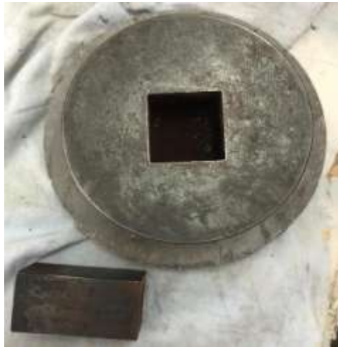
Şekil 12. Takım çeliğinden yapılmış kalıp
