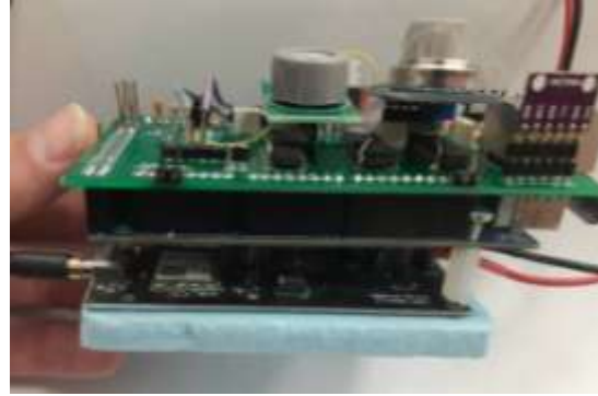
Şekil 6: Kontrol kartına entegre edilmiş GSM modülü ve Arduino kartı.
