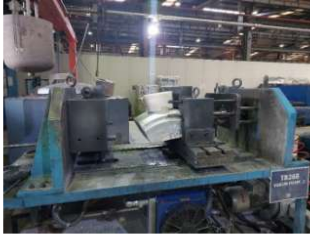
Şekil 3. Desen segmentlerinin imalatında kullanılan döküm sistemi
