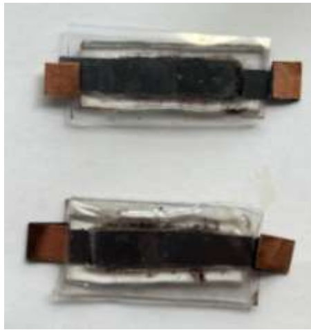
Şekil 14. Tam hücre yapılı montajlanmış süperkapasitör
