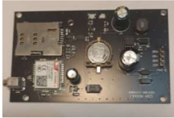
Şekil 7: Tasarımı ve üretimi yapılan GSM kartı.
