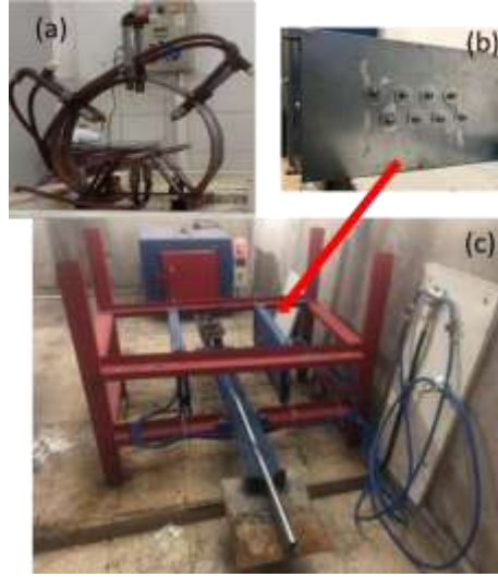
Şekil . Hava su atomize sistem revizyon 2 a) tasarımı tamamlanan sistem (b) hava atomize nozul sistemi bağlantı aparatı
