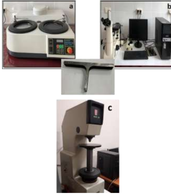
Şekil 3. Profillerin (merkezdeki görüntü) karakterizasyonunda kullanılan zımpara cihazı (a), Optik Mikroskop (b) ve sertlik cihazı (c).
