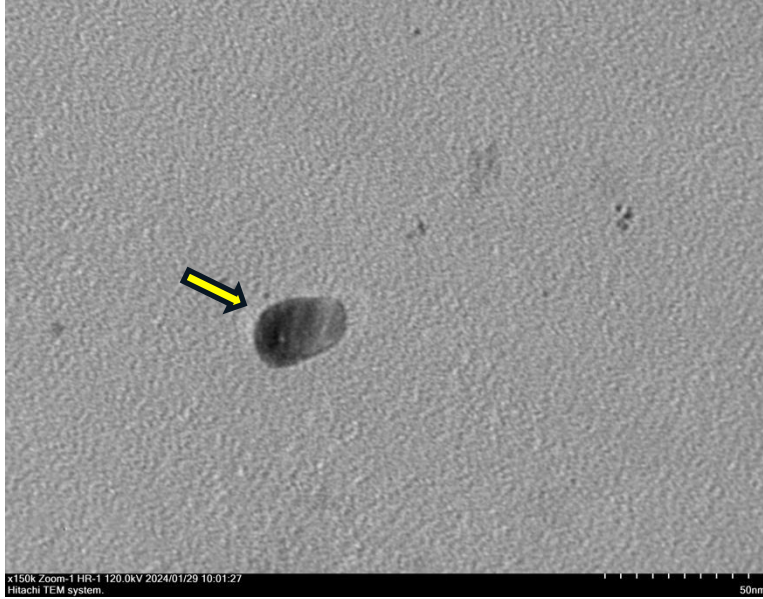
Şekil 1. Rezene tohumundan sentezlenen karbon kuantum noktaların TEM görüntüsü (skala: 50 nm).
