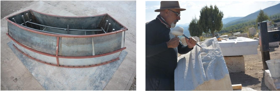
Şekil 20–21: Arşitrav Kalıbı ve İmitasyon Arşitrav İşleme.
