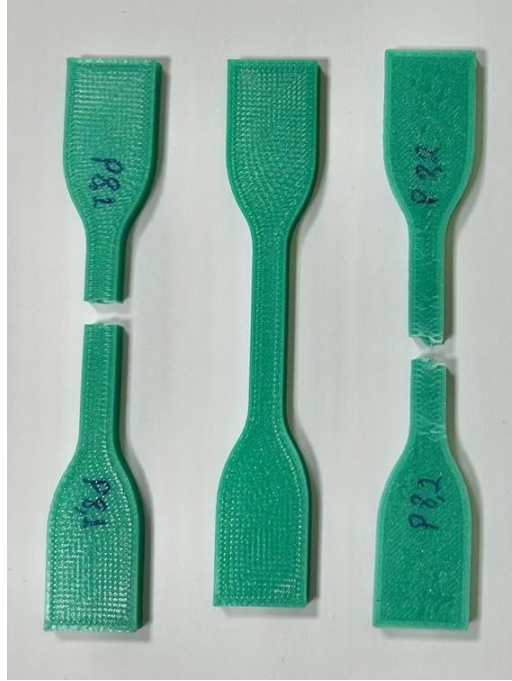
Şekil 5. Çekme test numunelerin öncesi ve deney sonrası kıyasla görüntüsü.
