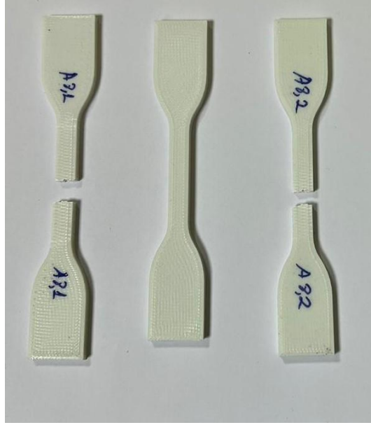
Şekil 5. Çekme test numunelerin öncesi ve deney sonrası kıyasla görüntüsü.
