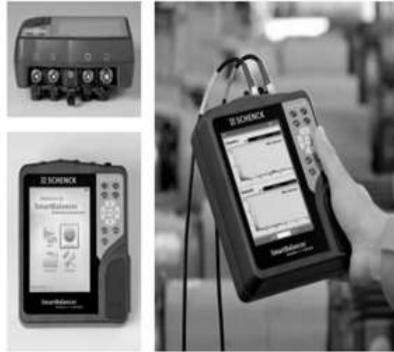
Şekil 2. Data değerlerini alabilen balans cihazı(Ülger, 2022).
