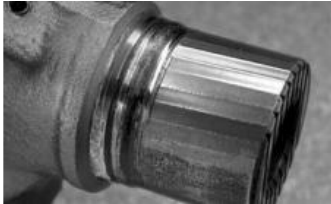
Şekil 3.5. İstavroz muylu yüzeyinin aşınması (Dana Spicer, 2008)
