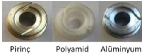
Şekil 2. Farklı malzemelerden yapılan 2 çıkışlı nozullar
