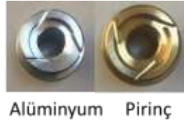
Şekil 2. Alüminyum ve pirinç nozul
