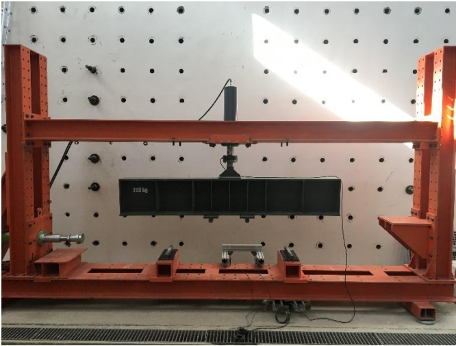
Şekil 5. Hidrolik pres makinesi deney düzeneği
