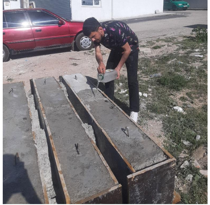
Şekil 4. Numunelerin hazırlanması ve Kürü işlemleri
