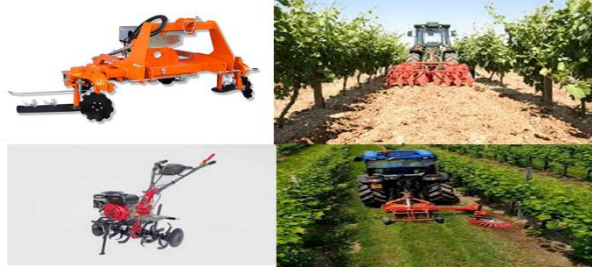
Şekil 2. Bahçe bitkileri tarımında yaygın olarak kullanılan toprak işleme makinaları
