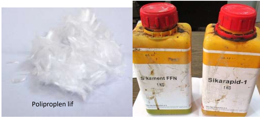
Şekil 2. Çalışmada kullanılan polipropilen elyaf ve akışkanlaştırıcı katkıları.
