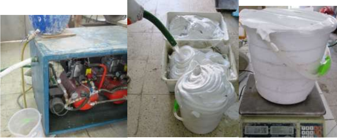
Şekil 3. Köpük üretimi ve köpük yoğunluğunun kontrol edilmesi.
