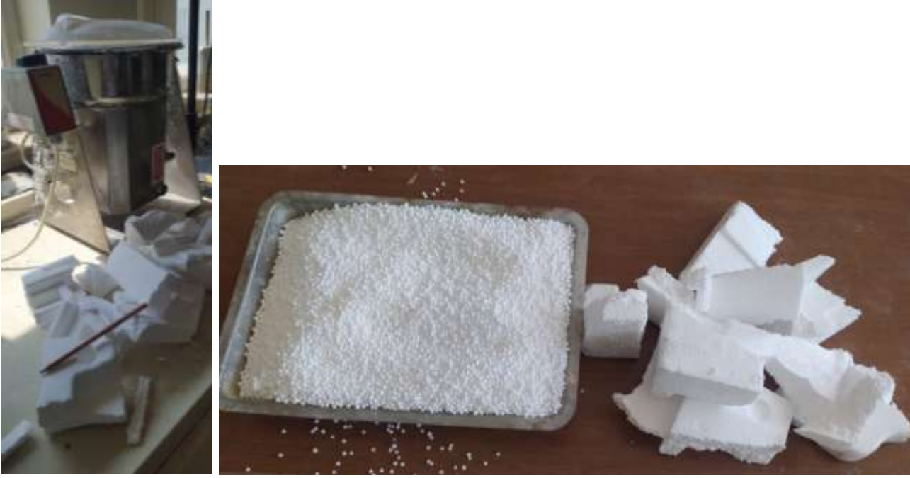
Şekil 1. EPS öğütücü cihaz (solda) ve EPS'nin atık haldeki ve öğütülerek taneli hale getirilmiş görünümü (sağda).
