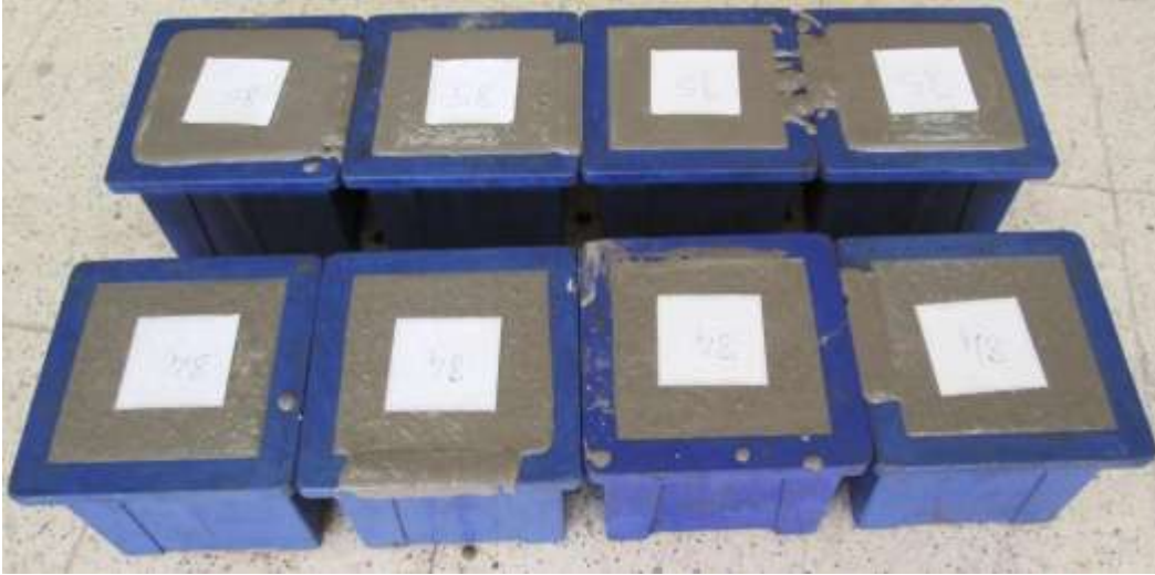
řekil 5. EPS katkılı harcın kalıplara dklmesi.
