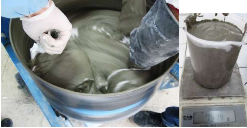
řekil 4. alıřmada kullanılan pan tipi mikser (solda) ve yoęunluk lm (saęda).
