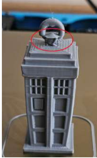
Şekil-2. Aşırı Sıcaklık Sonucu Oluşan Akma Problemi
