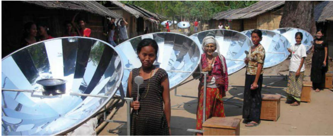
Şekil 9. Parabolik kolektörlü solar ocakların afet bölgesinde kullanımı ("Solarcooking," 2024)
