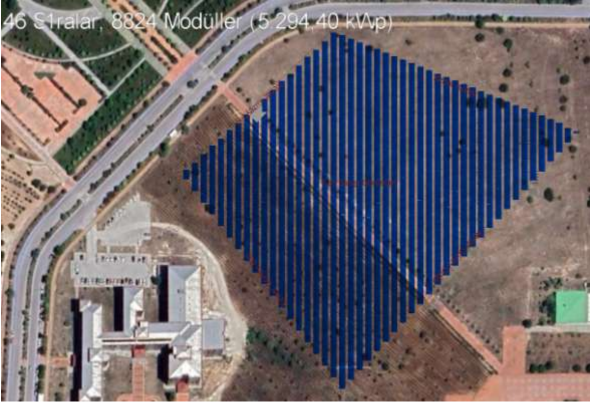
Şekil 3.1. Güneş paneli yerleşimi PVSOL gösterimi
