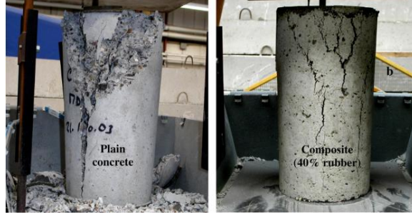
Şekil 3. % 40 GDK katkılı ve referans numune testleri(Benazzouk et al., 2007)
