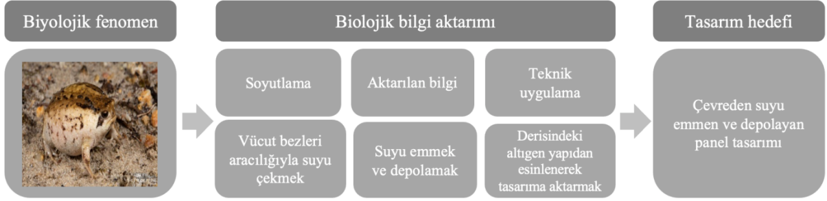
Şekil 17. Yağmur kurbağasının su toplama tekniğinin tasarıma aktarımı
