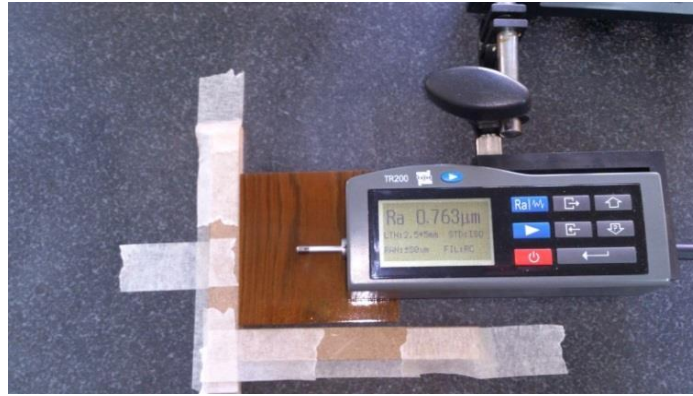
Şekil 1. Ahşap örneklerde pürüzlülük ölçümü.
