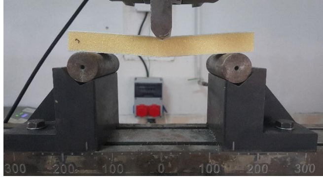
Şekil 4. Sandviç kompozit numunenin eğme testi
