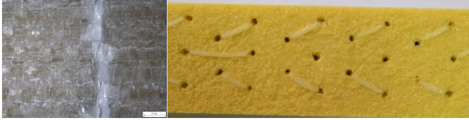
Şekil 7. Güçlendirilmiş sandviç yapının eğme hasarı sonrası yüzey ve çekirdek tabakanın görüntüsü (çekirdek takviye elemanlarının görüntülenebilmesi için yüzey tabaka çekirdek üzerinden kaldırılmıştır)
