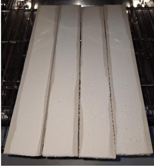
Şekil 1. Ragle ile ham sır uygulanmış karo numuneleri
