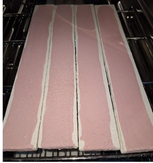
Şekil 1. Ragle ile ham sır uygulanmış karo numuneleri
