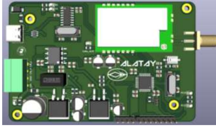
Şekil 7. Alıcı -verici devresi 3 boyutlu görünümü
