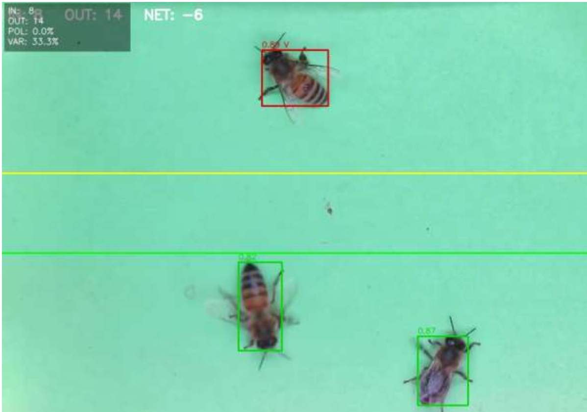
Şekil 7. Çalışan işlem hattından alınmış anotasyonlu örnek kare (sahnede 3 arı); sarı çizgi L 1 , yeşil çizgi L 2 , sol üstteki HUD anlık IN/OUT sayaçlarını ve kare düzeyindeki polen/Varroa oranlarını gösterir. Kırmızı kutu, modelin Varroa-pozitif tahminini göstermektedir; bu kare için saha doğrulamalı gerçek etiket bulunmamaktadır. Gecikme ve FPS değerleri bu kareden değil, Tablo 4 ve Tablo 5'teki ölçümlerden okunmalıdır.
