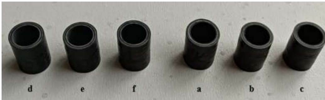
Şekil 1. Yakma deneyinde kullanılan kompozit boru numuneleri
