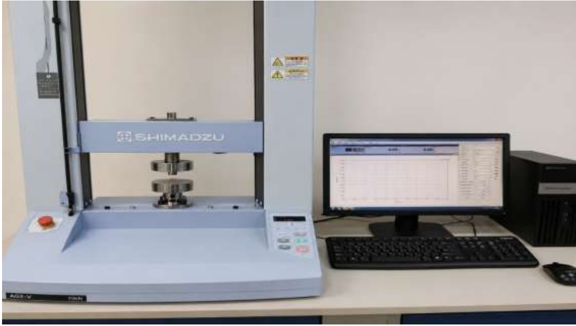
Şekil 1. ASTM D2412 standardına uygun olarak gerçekleştirilen radyal basma deney düzeneği (Shimadzu AGS-X 10 kN).
