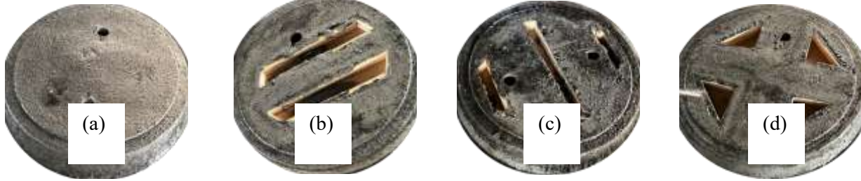
Şekil 9 : Beton dökümü tamamlanan dört farklı rögar kapağı numunesi: (a) Orijinal SASKİ kapağı, (b) İki kanallı rögar kapağı, (c) Üç kanallı rögar kapağı, (d) T tipi rögar kapağı
