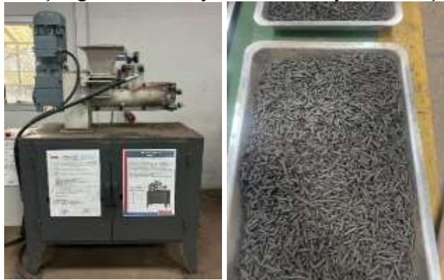
Şekil 1: Kardökmak Ar-Ge laboratuvarında vakum ekstruder ile briket üretimi
