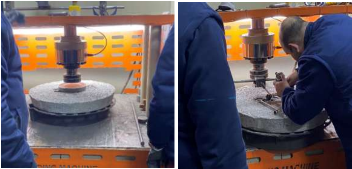
Şekil 10: Orijinal SASKİ kapağının yük taşıma deneyi öncesi hazırlık aşaması
