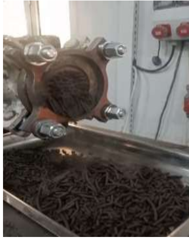
Şekil 1: Kardökmak Ar-Ge laboratuvarında vakum ekstruder ile briket üretimi
