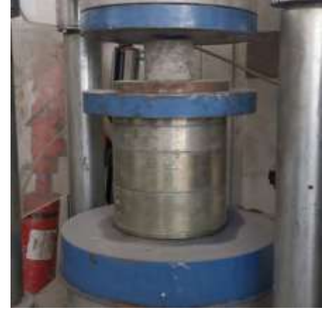
Şekil 8: Karot numunelerinin basınç dayanımı test düzeneği
