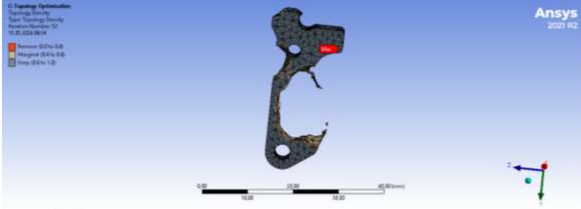
Şekil 4. Topoloji optimizasyon uygulanmış horoz mekanizması
