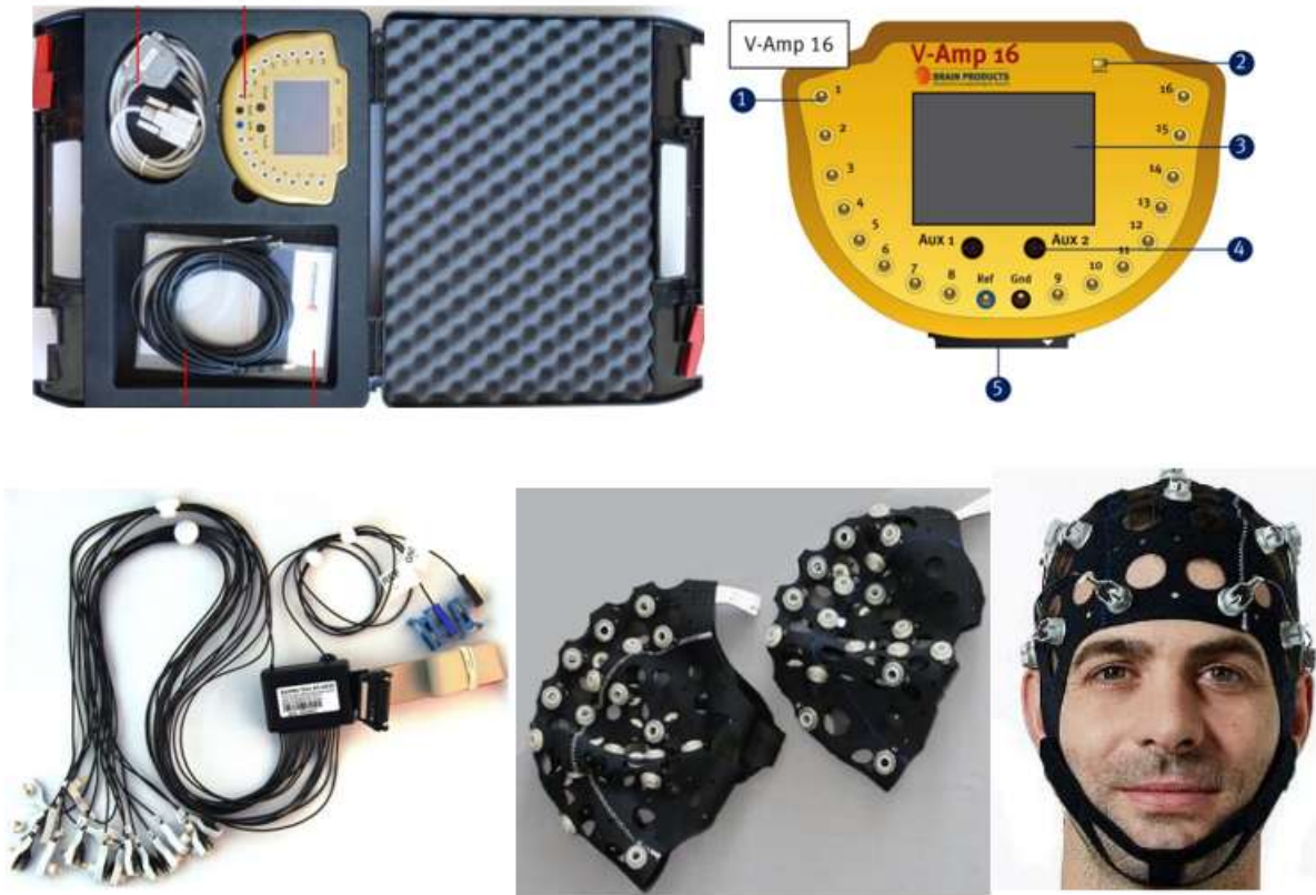
Şekil 2. Brain Products Vamp 16 kanallı EEG cihazı ve aksesuarları.
