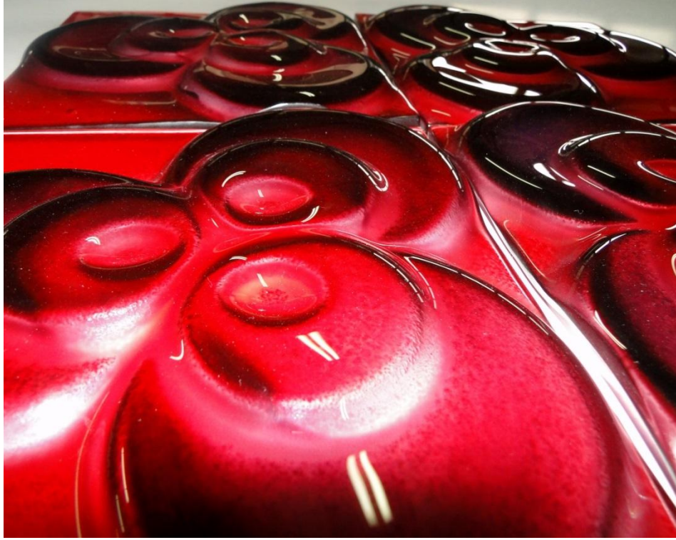
Şekil 6. Kalıp Üzerine Çökertme Örneği. (Kişisel Arşiv)
