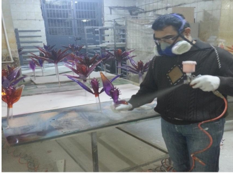
Şekil 10. Açık Alevde Şekillendirilen Cam Formların Renklendirilmesi (Kişisel Arşiv)
