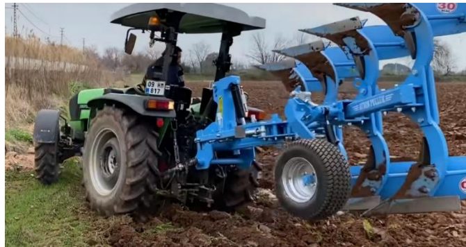
Şekil 4. Asma döner kulaklı pulluk tarla dönüşü (Anonim).
