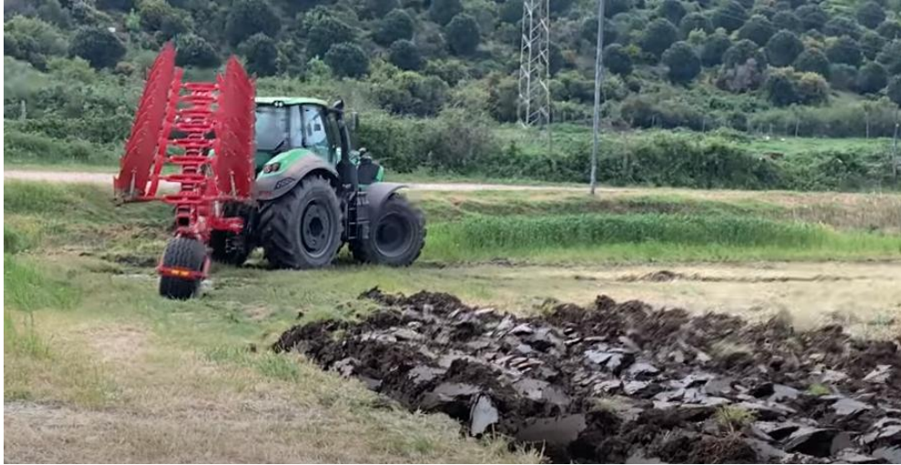
Şekil 6. Yarı asma döner kulaklı pulluk tarla dönüş-1 (Anonim).
