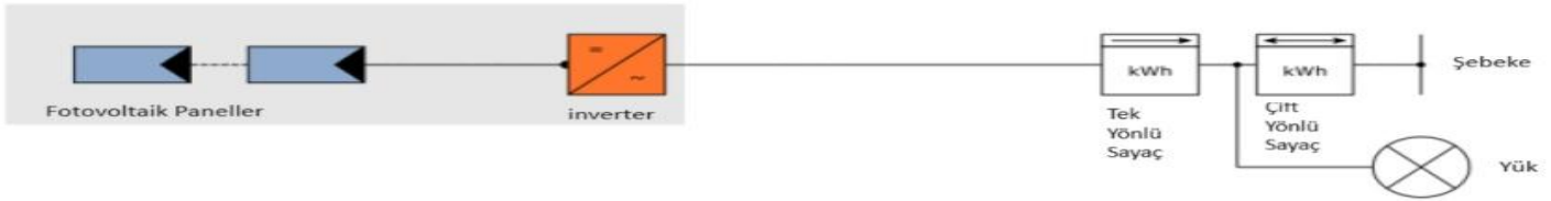
Şekil 9. Fotovoltaik sistemin devre şeması (PVSOL)
