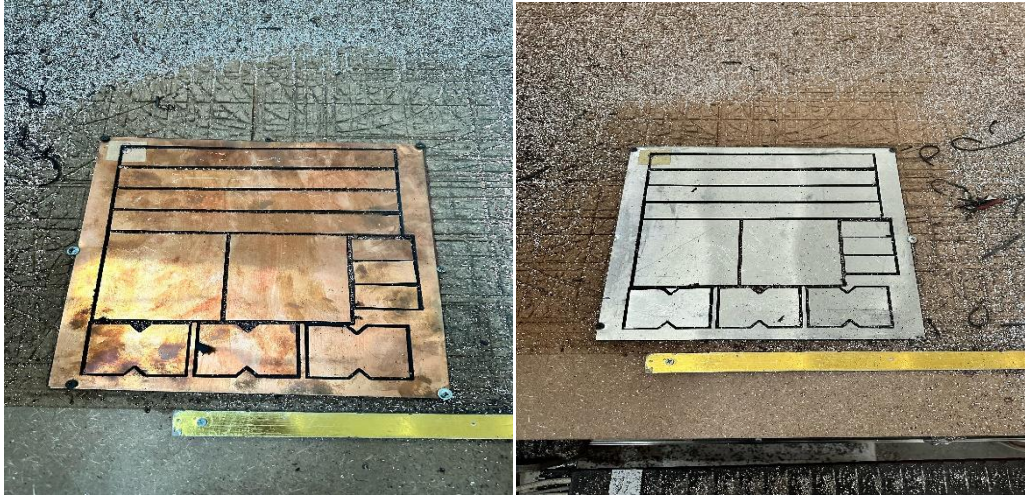
Şekil 2.2.1. ASTM ölçülerine göre kesimi yapılan numuneler
