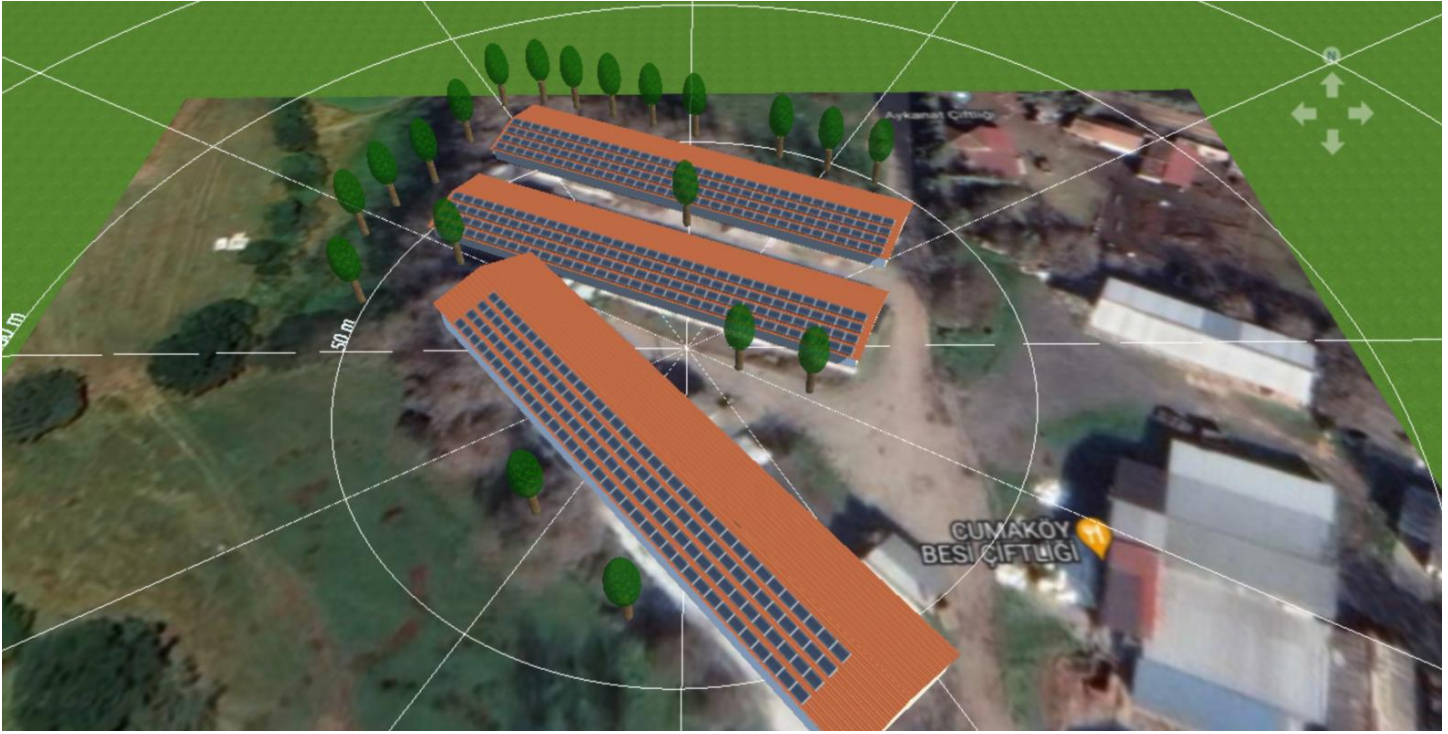
Şekil 17. Gölgenmeli durumda (Ağaçlar varken) güneye bakan çatı yüzeylerine FV sistem uygulaması
