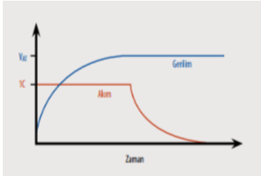
Şekil 14. Lityum iyon pillerinin şarj edilmesi.
