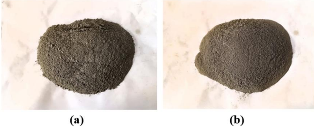
Şekil 1. Grout karışımları için kullanılan malzemeler: (a) Portland çimentosu (PÇ), (b) Uçucu kül (UK).
