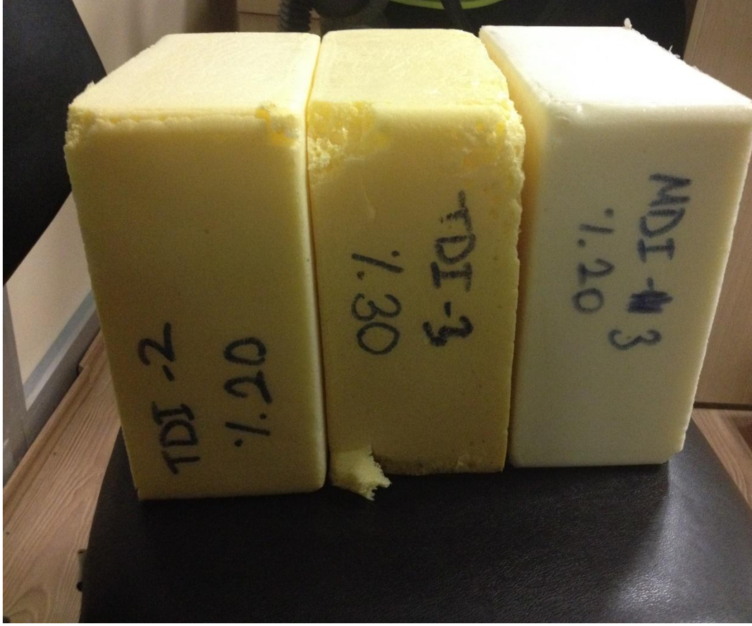
Şekil 1: TDI ve MDI kullanılarak üretilmiş, içerisinde farklı oranlarda faz değıştiren malzeme içeren süngerler
