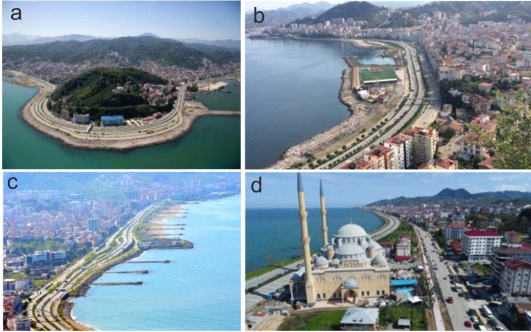
Şekil 2. KSY'na ait Giresun ve Bulancak bölgesinden görüntüler (a: yarımada tamamen deniz dolgusu ile çevrilmiş, b: yarımadanın doğusunda Gemiler Çekeği'nde iç yol ve KSY'nun büyük bir kısmı ile spor kompleksi tamamen deniz içinde, c: yarımadanın batısında Kumyalı, Çıtlakkale, Teyyaredüzü, Erikliman arasında KSY neredeyse tamamen deniz dolgusu üzerinde, d: Bulancak'ta çoğunlukla yüksek deniz dolgusu üzerinde) (URL-1, URL-2, URL-3, URL-4)
