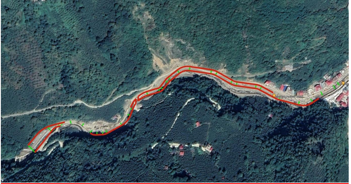
Şekil 4. Dereli yukarı havzada taşkına karşı yatak düzenleme, duvar ve britlerin bulunduğu bölge (kırmızı çizgiler duvarlardır, çizim: Okan Yonkuç)
