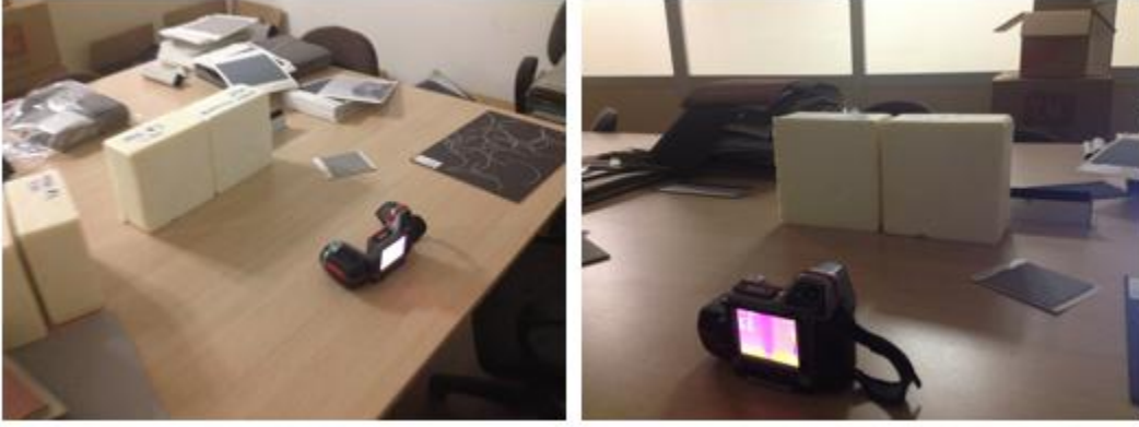
Şekil 10: Oda koşullarında sünger yüzeyindeki sıcaklık değerlerinin termal kamerayla ölçülmesi
