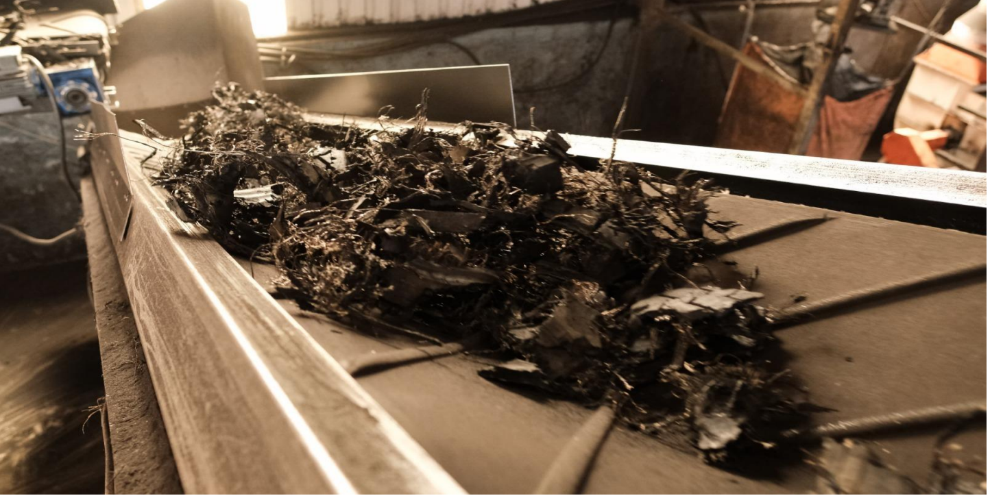
Şekil 1. Atık Taşıtlı Lastiği Mekanik Ayrıştırma Süreci (kaynak : http://yakupogullari.com.tr/galeri/ )
