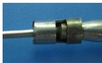
Resim 13: Termostat Bulb Teline Koruma Kapağı İlavesi
