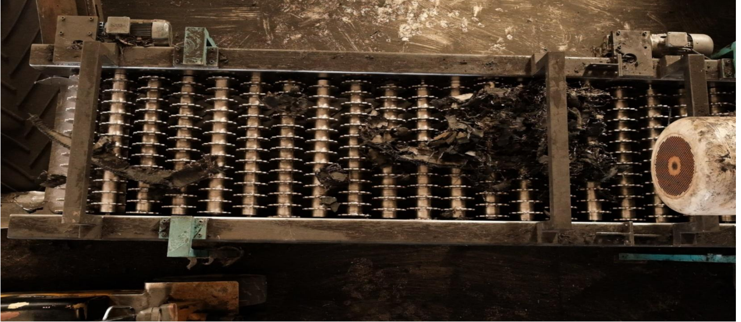
Şekil 1. Atık Taşıtların Mekanik Ayrıştırma Süreci (kaynak : http://yakupogullari.com.tr/galeri/ )
