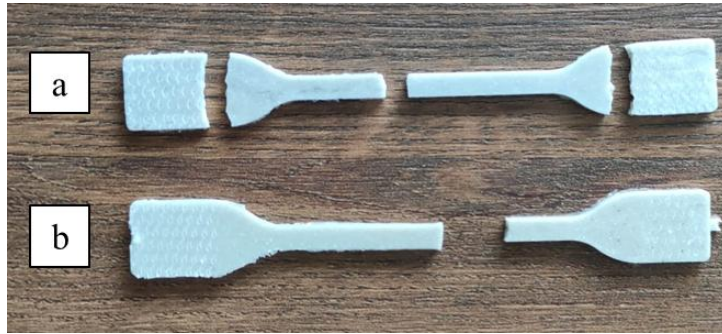
Şekil 1. Kemik tozu takviyeli polimer matrisli kompozit malzeme; a) topaklanma sonucu yanlış yerden kopan numune, b) yüzey modifikasyon sonucu topaklanma oluşmamış numune
