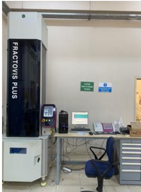
Şekil 4. Fractovis marka darbe test cihazı
