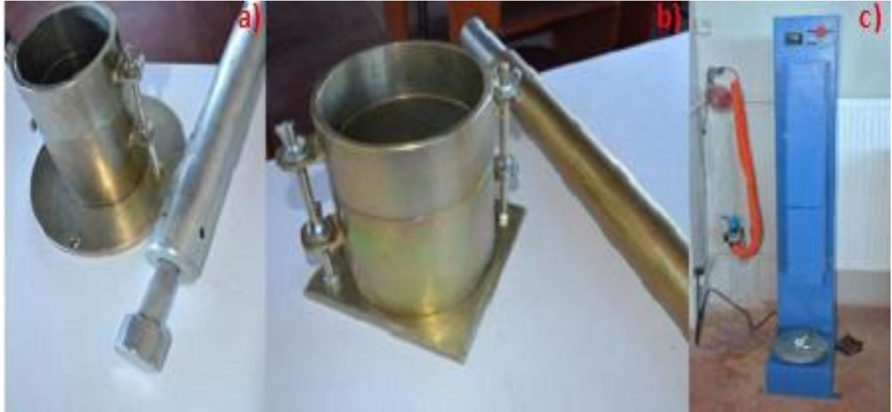
Şekil 1. Proctor deneyi ekipmanları a) Standart Proctor b) Modifiye Proctor c) Otomatik kompaktör
