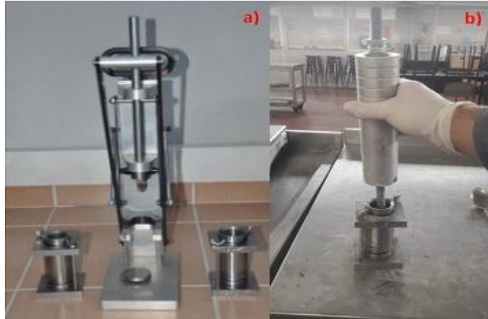
Şekil 2. Harvard minyatür kompaktör ekipmanları a) kalıp ve numune çıkarıcı b) tokmak
