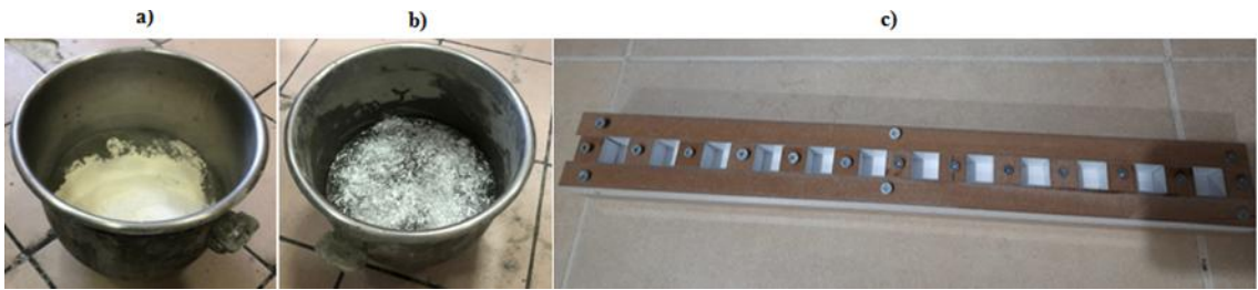
Şekil 2.1. a) Lifsiz karışım, b) Lifli karışım ve c) Özel üretilmiş 2x2x2cm 3 boyutlardaki kalıp
