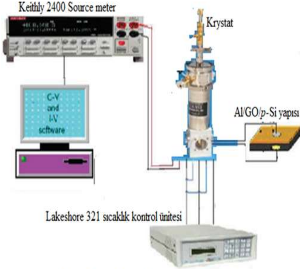
Şekil-1. Al/GO/ p -tipi Si yarı iletken yapısının ölçüm sistemi
