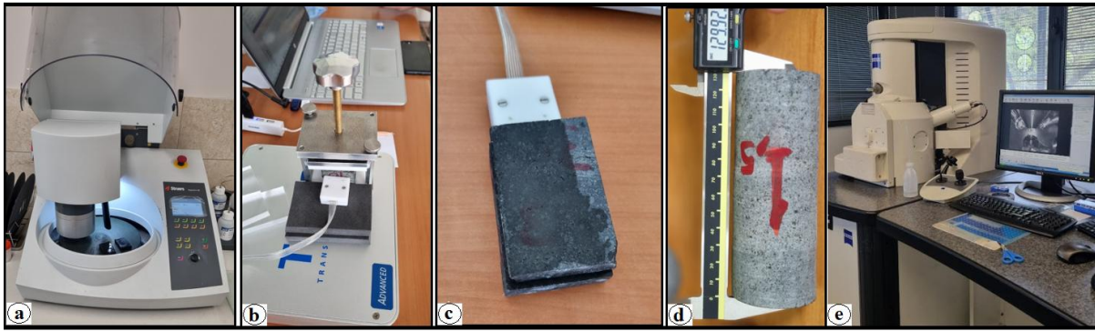
Şekil 2. Deneyle tabi tutulan bazı örnekler; yüzey düzeltme işlemi (a), ısı iletkenlik ölçümleri (b, c), porozite için hacim hesaplama (d), TEM(Taramalı Elektron Mikroskop) analizi(e)
