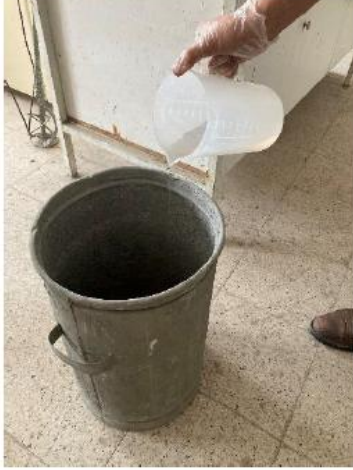
Hazırlanan alkali çözelti karıştırma haznesine konmuştur.
