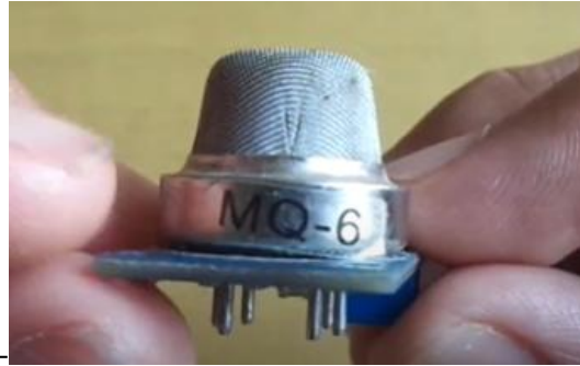
Şekil 2.2. Projede kullanılan MQ – 6 gaz sensörü
