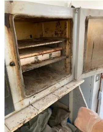
Etüvde 24 saat süreyle 65 °C sıcaklıkta kür edilmiştir.
