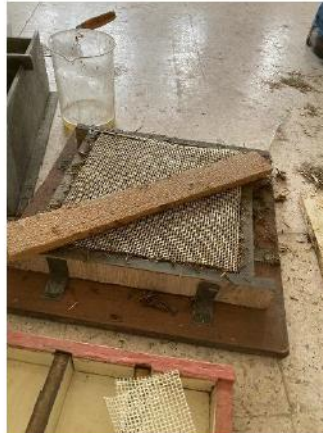
Yüzeyi düzeltilen numune sıva filesi ile örtülmüştür.
