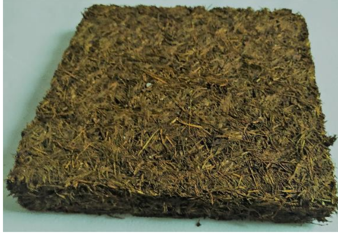
Şekil 3. Çimen lifinden geopolimer yöntemi ile üretilen yalıtım plakası (30x30x5 cm).
