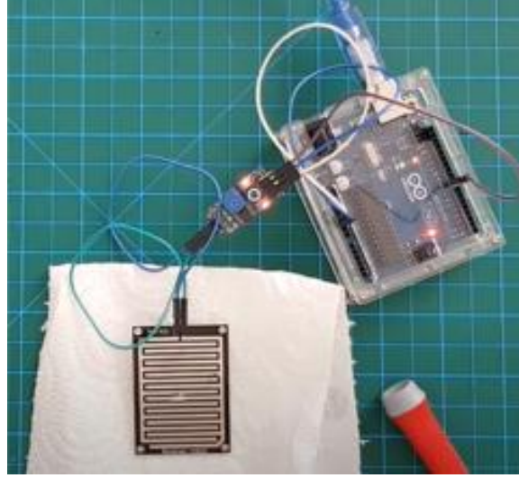
Şekil 2.5. Projede kullanılan yağmur sensörü
