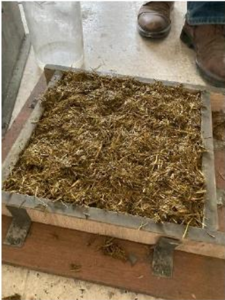
Karıştırma işlemi sonrası kalıplama işlemi başlamıştır.
