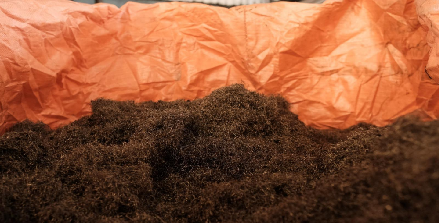
Şekil 2. Mekanik Ayırıştırma Sonrası Atık Taşıtlı Lastik Çeliği (kaynak : http://yakupogullari.com.tr/galeri/ )
