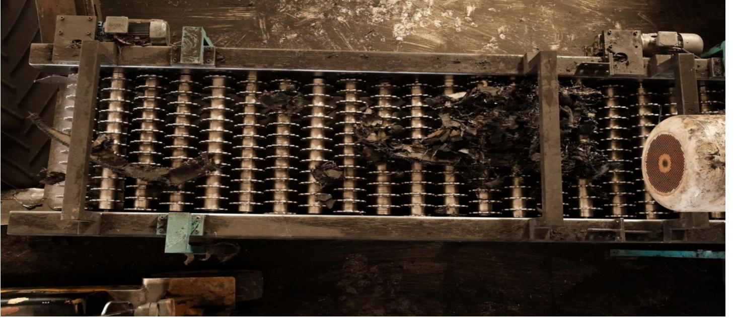
Şekil 1. Atık Taşıtların Mekanik Ayrıştırma Süreci (kaynak : http://yakupogullari.com.tr/galeri/ )
