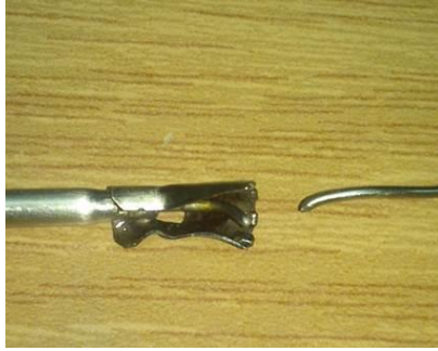
Resim 5: 2.Termostat hiç çalışmıyor (Bulb teli kırılma)
