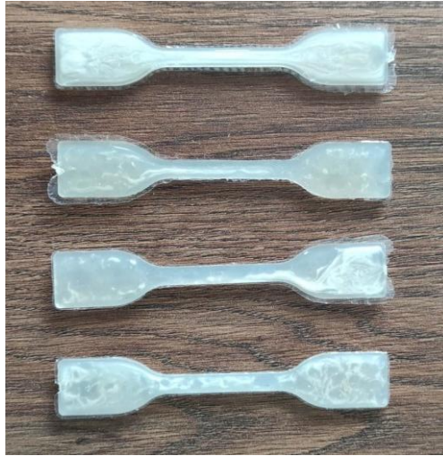
Şekil 3. Düzensiz ve homojen olmayan bir katılma sonucu üretilen hatalı numuneler
