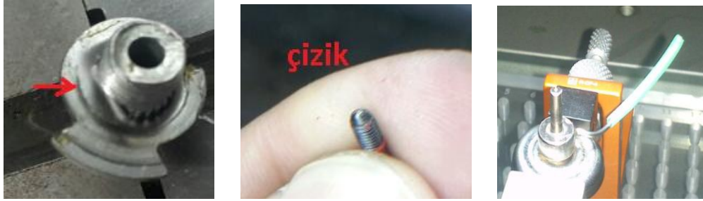
Resim 11: Setuskur Vidasının Mile Yapıştırılma İşlemi
