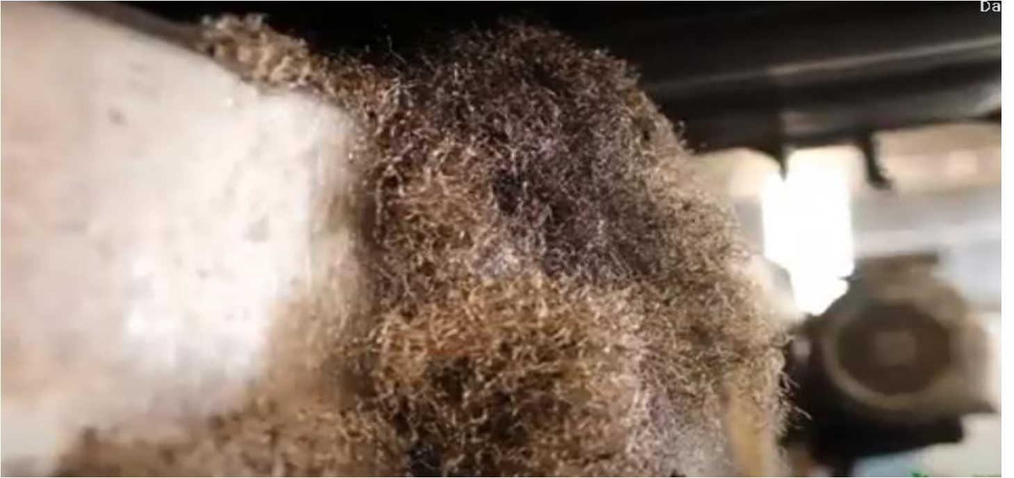
Şekil 2. Mekanik Ayrıştırma Sonrası Atık Taşıtların Lastik Çeliği (kaynak : http://yakupogullari.com.tr/galeri/ )
