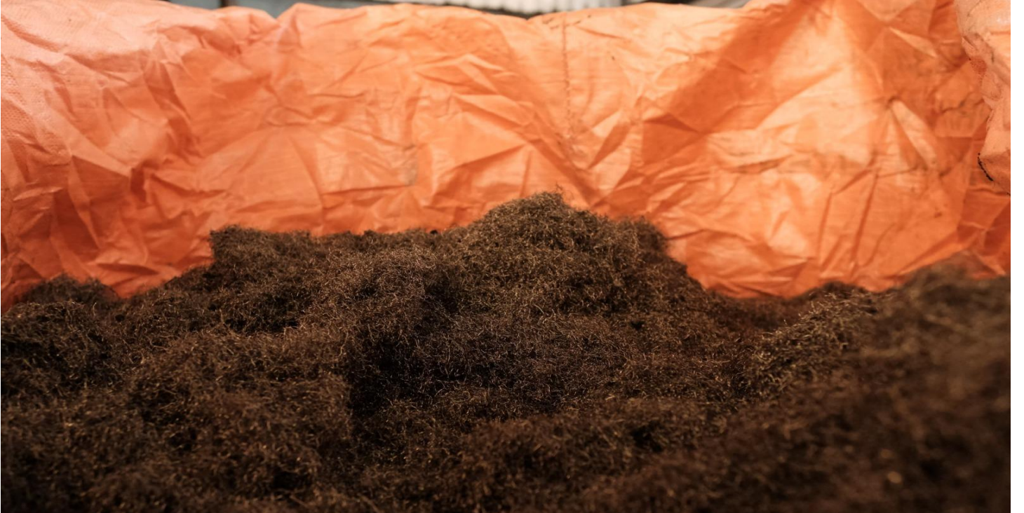
Şekil 2. Mekanik Ayırıştırma Sonrası Atık Taşıyıcı Lastik Çeliği (kaynak : http://yakupogullari.com.tr/galeri/ )
