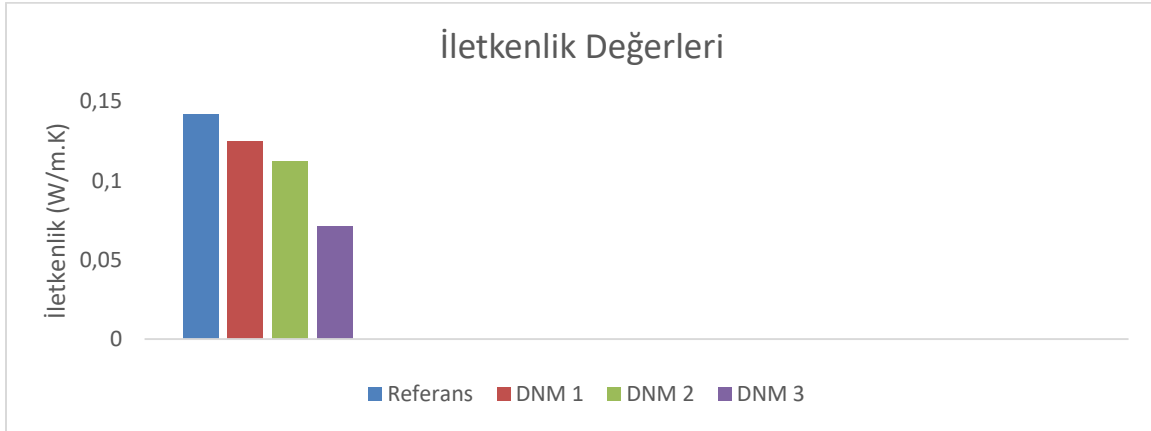
Şekil 3. Köpük betonların iletkenlik sonuçları.
