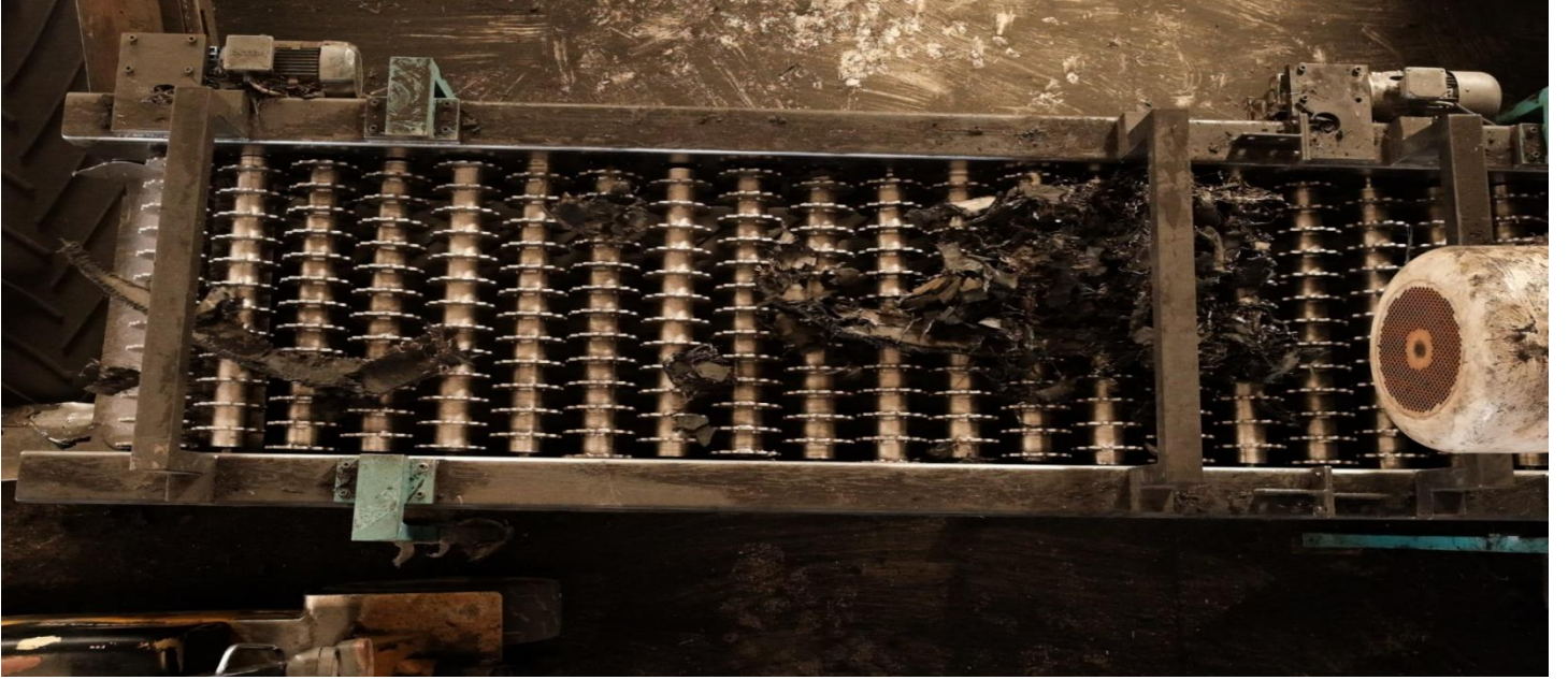
Şekil 1. Atık Taşıt Lastiği Mekanik Ayrıştırma Süreci (kaynak : http://yakupogullari.com.tr/galeri/ )
