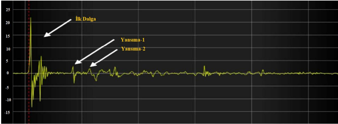
Şekil 4. Farklı frekanslı bileşenlerden oluşan arıza yeri tespit edici ölçüm kayıt grafiği
