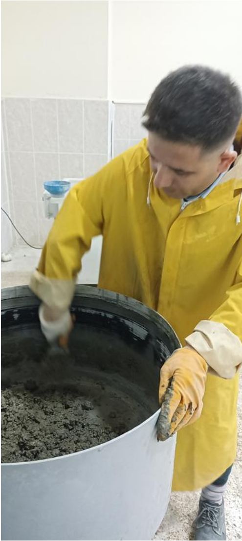
Şekil 3. Deney numunelerine ait harcın mikserde hazırlanma aşaması
