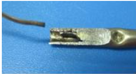
Resim 13: Termostat Bulb Teline Koruma Kapağı İlavesi
