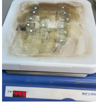
Şekil 1: TiO 2 ve ZnO fotoanotların tavllanması
