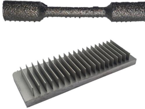
Şekil 1. SLM yöntemiyle üretilmiş, yüzeyleri pürüzlü numuneler [8].
