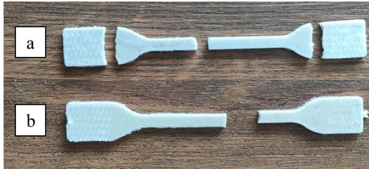
Şekil 1. Kemik tozu takviyeli polimer matrisli kompozit malzeme; a) topaklanma sonucu yanlış yerden kopan numune, b) yüzey modifikasyon sonucu topaklanma oluşmamış numune
