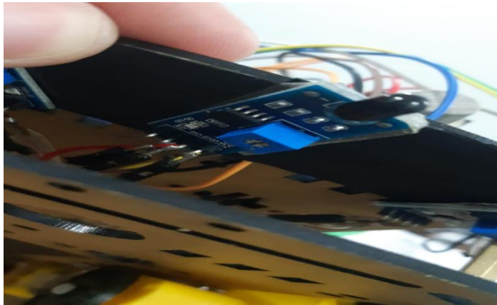
Şekil 5. Alev Sensörünün Taşıt İçerisindeki Konumu
