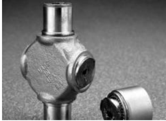
Şekil 3.4. İstavrozun kırılması (Dana Spicer, 2008)
