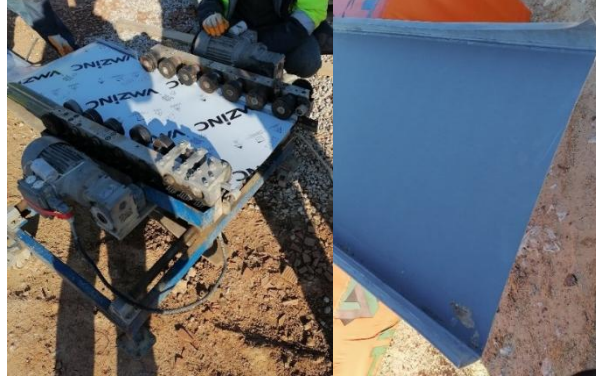
Şekil 10: Metal rulonun istenilen ölçülerde bükümünün yapılarak levha haline getirilmesi.
