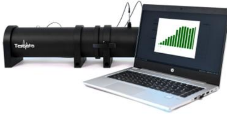
Şekil 8. Dört mikrofonlu empedans tüp (Özgür, 2023)
