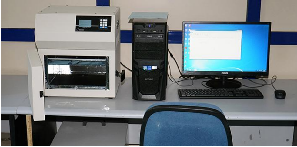
Şekil 5. Isı iletim katsayısı tespiti ölçüm cihazı (Özgür, 2022)
