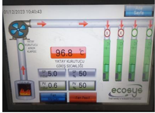
Şekil 3. Kurutma Atık Isı Geri Kazanım Kontrol Panosu Üzerinde, Sistemin İzlenmesi
